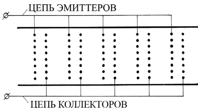
Рисунок 4.4. Схема магистрального ЭГД-насоса.
