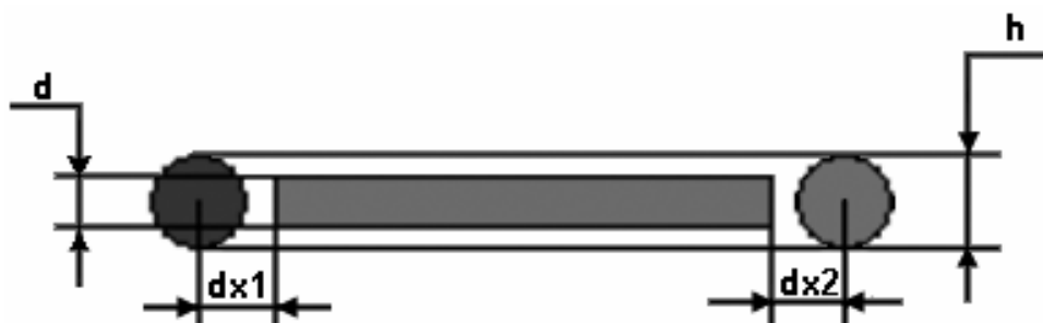
Рисунок 4.28. Геометрия межэлектродного промежутка, темной полосой выделена область приложения объемного заряда
