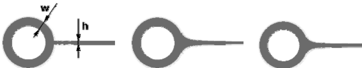
Рисунок 3.97. Области локализации объемного заряда у активного электрода на первом, втором и третьем шаге итераций, соответственно.
