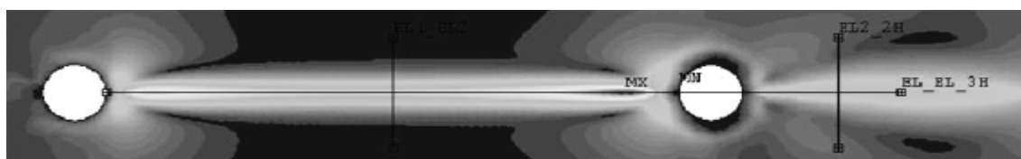
Рисунок 3.101. Контурный график скорости сквозного течения при наличии «длинных» биполярных струй за пределами пассивного электрода
