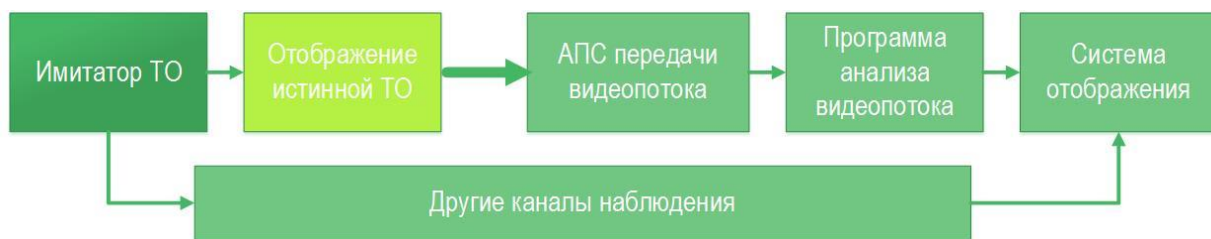
Рисунок 2 – Структура ПО стенда моделирования оптоэлектронного канала наблюдения
