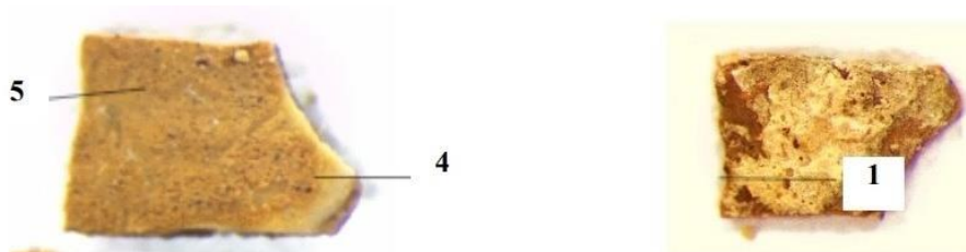
Изображение пробы красочного слоя с лицевой и тыльной стороны в отражённых видимых лучах, увеличение 40 x
