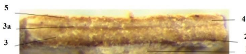
Изображение поперечного среза пробы красочного слоя на штукатурке в отражённых видимых лучах, увеличение 40 x
