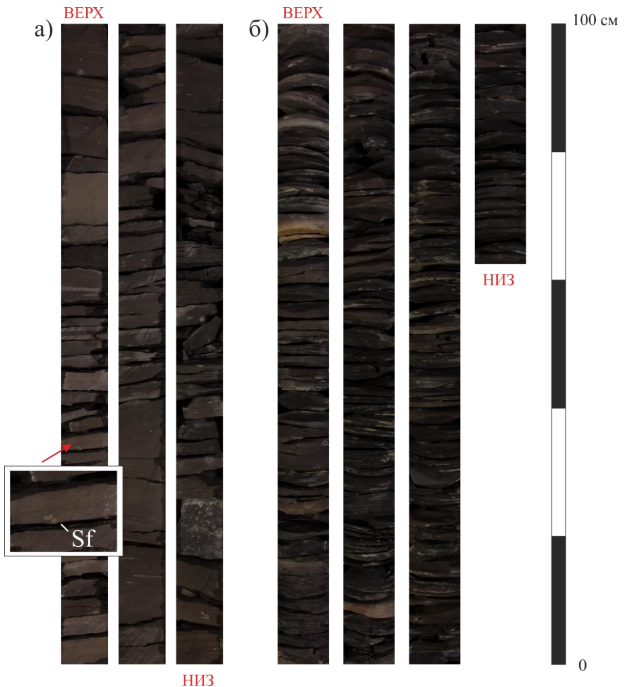
Рисунок 16 Слои типа ХА Нижняя подсвета васюганской свиты а) керн скв. № 5; б) керн скв. № 8. Sf-стяжения сульфидов
