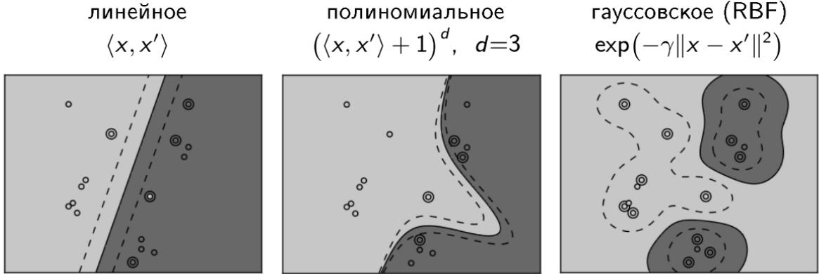
Рис. 3: Примеры зависимости формы разделяющей поверхности (кривой) от типа ядра
