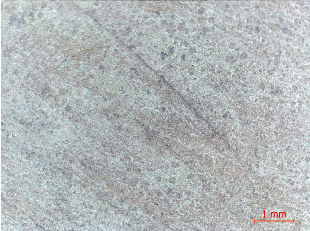
Рис. 9. Поверхность образца №1 искусственного патинирования химическим методом. До проведения испытания.
