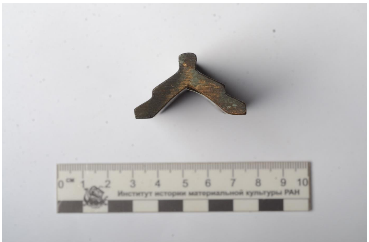
Рис. 40. Образец №4 искусственного патинирования методом холодного газодинамического напыления (ХГН). После проведения испытания.
