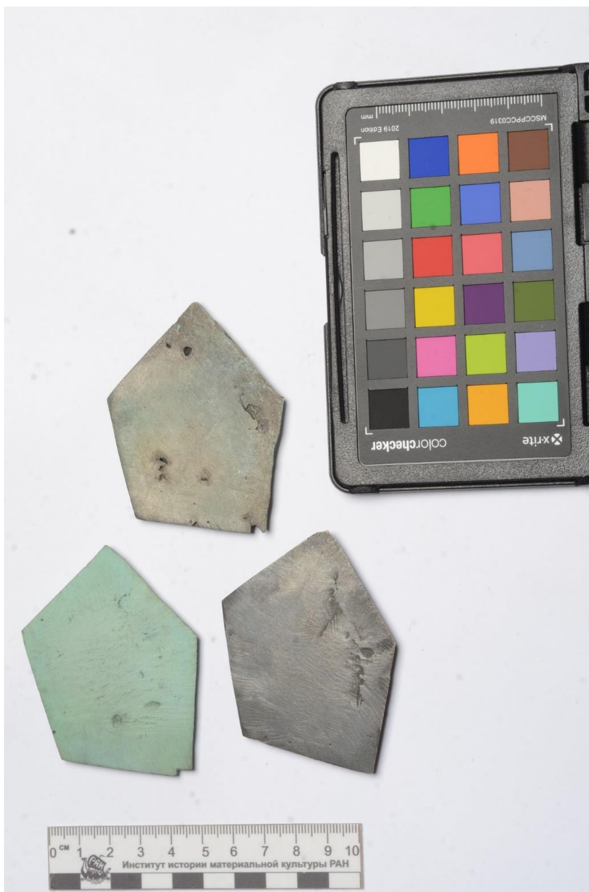
Рис. 1. Образцы, покрытые химическим методом искусственного патинирования. До проведения испытания.
