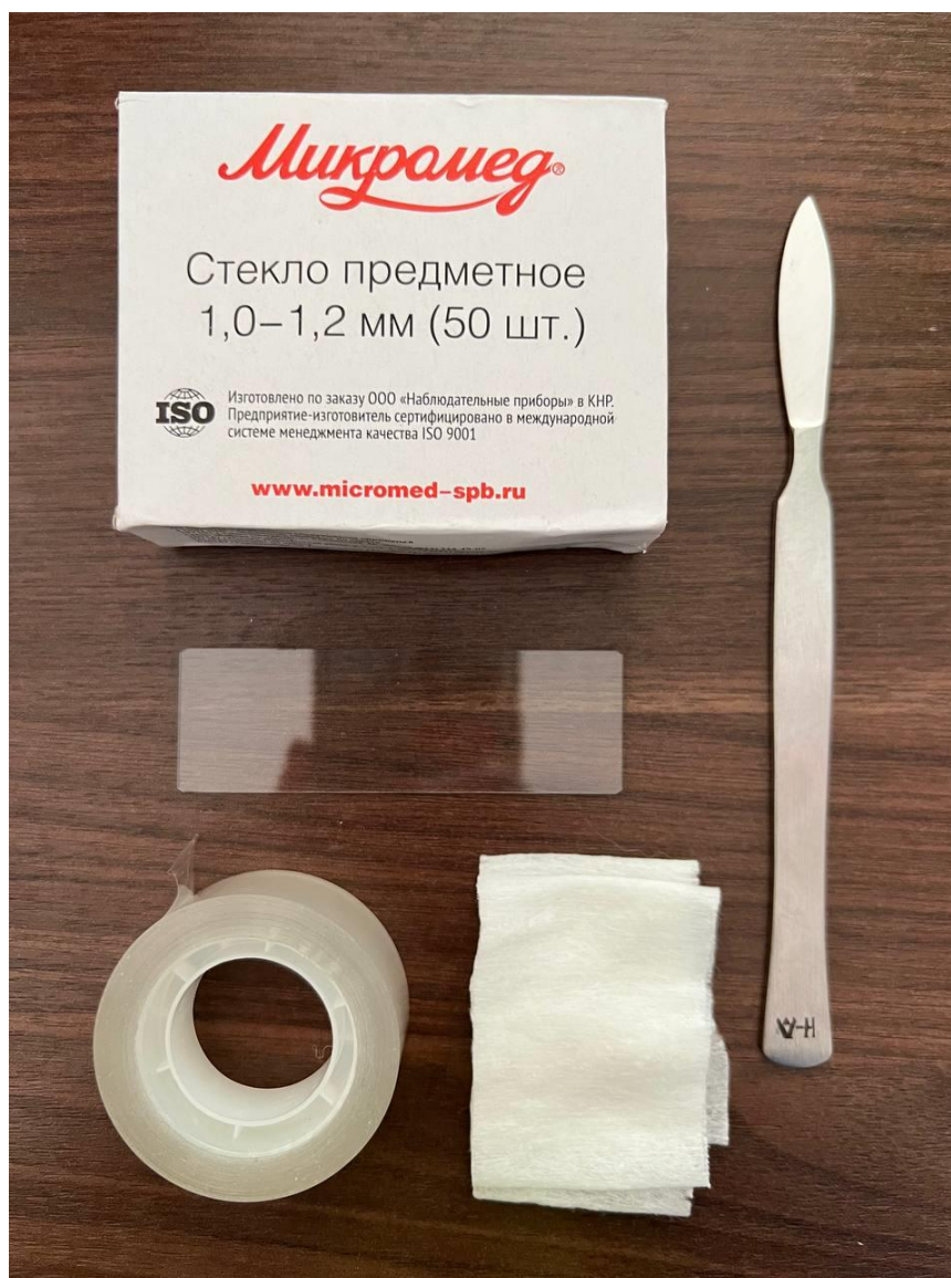
Рис. 26. Материалы и инструменты (стекло предметное (1,0-1,2 мм, «Микромед»), скальпель, ветошь, скотч).
