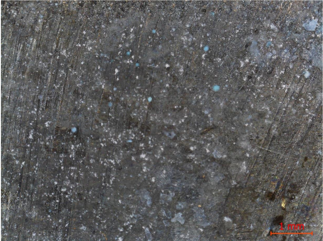
Рис. 56. Поверхность образца №2 искусственного патинирования химическим методом. После проведения испытания.
