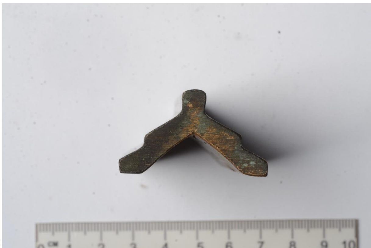
Рис. 7. Образец №4 искусственного патинирования методом холодного газодинамического напыления (ХГН). До проведения испытания.
