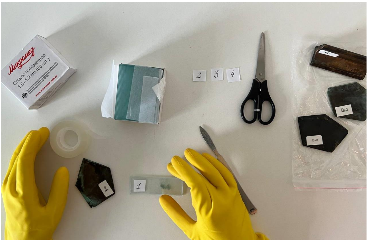
Рис. 28. Упаковка и герметизация отобранных образцов искусственной патины.
