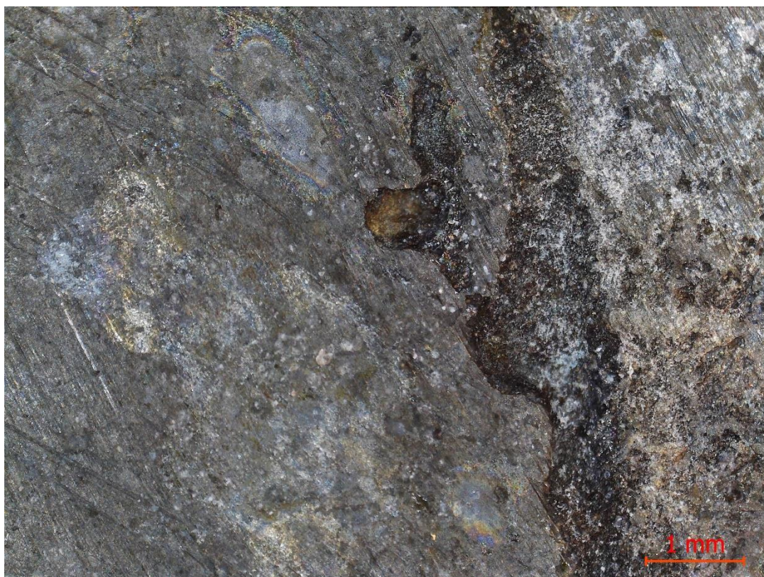
Рис. 50. Поверхность образца №2 искусственного патинирования химическим методом. После проведения испытания.
