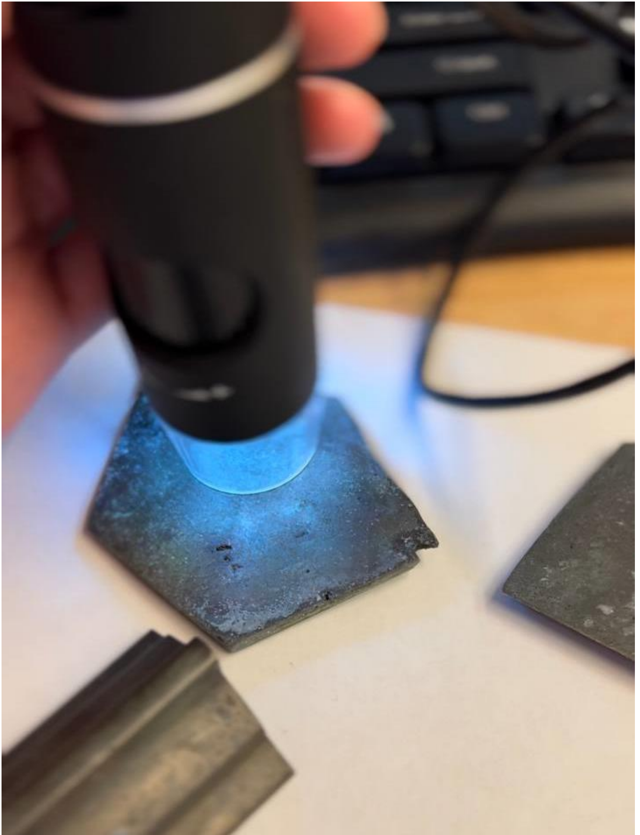
Рис. 32. Фиксация поверхности образцов, после проведения испытания, при помощи цифрового микроскопа DTX 90.
