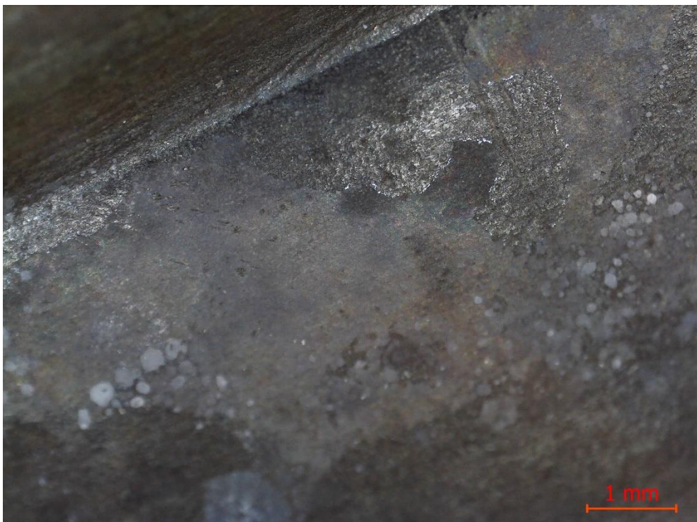
Рис. 68. Поверхность образца №4 искусственного патинирования методом холодного газодинамического напыления (ХГН). После проведения испытания.
