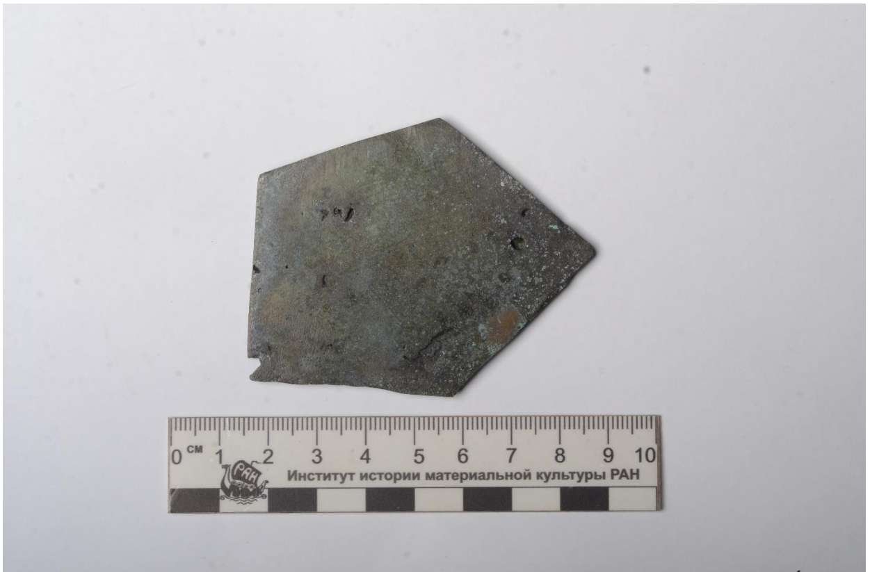
Рис. 35. Образец №1 искусственного патинирования химическим методом. После проведения испытания.
