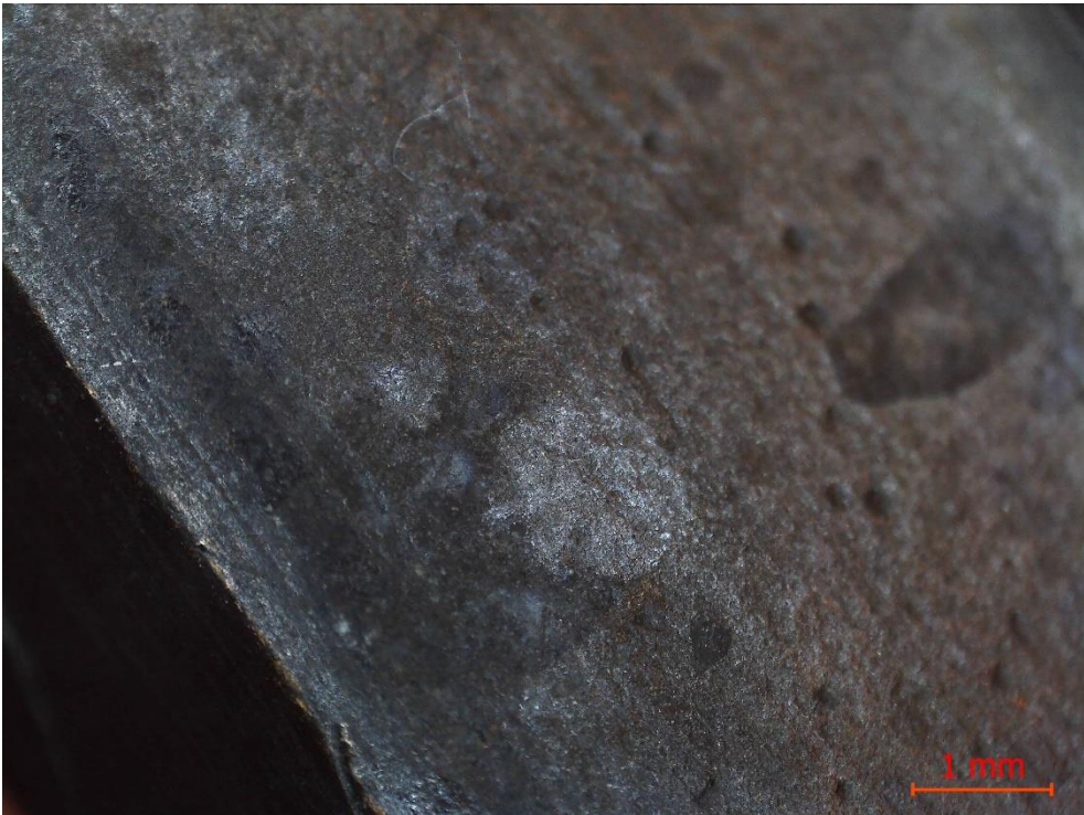
Рис. 73. Поверхность образца №4 искусственного патинирования методом холодного газодинамического напыления (ХГН).
