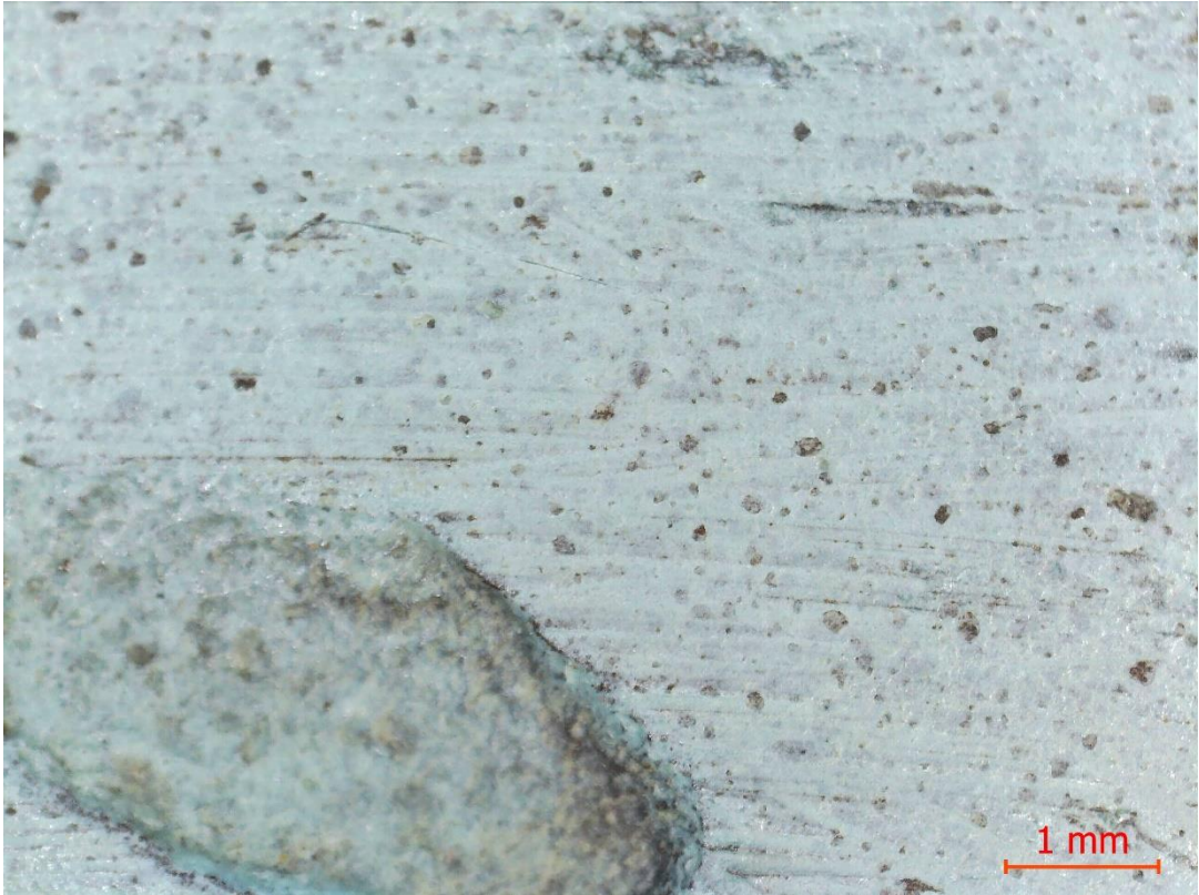
Рис. 62. Поверхность образца №3 искусственного патинирования химическим методом. После проведения испытания.
