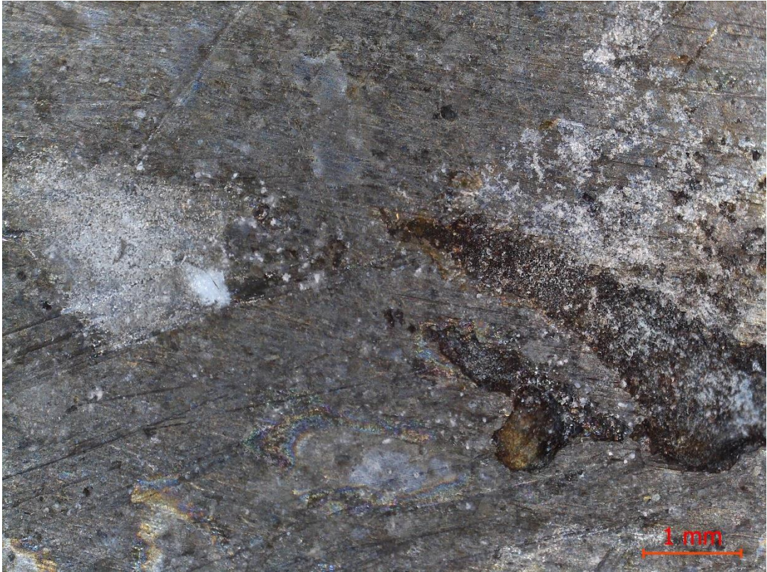
Рис. 53. Поверхность образца №2 искусственного патинирования химическим методом. После проведения испытания.
