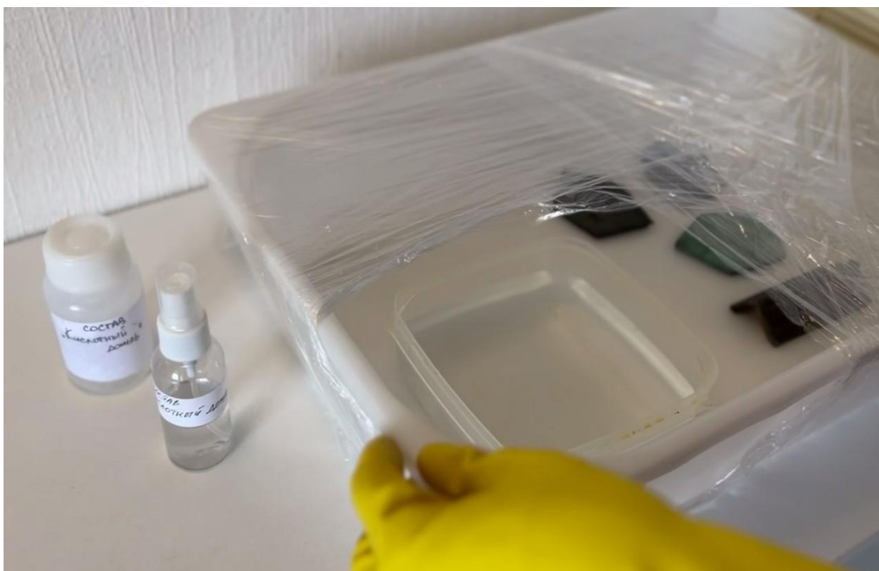
Рис. 30. Помещение образцов во влажную камеру, с применением повторяющегося распыления состава «Кислотный дождь».
