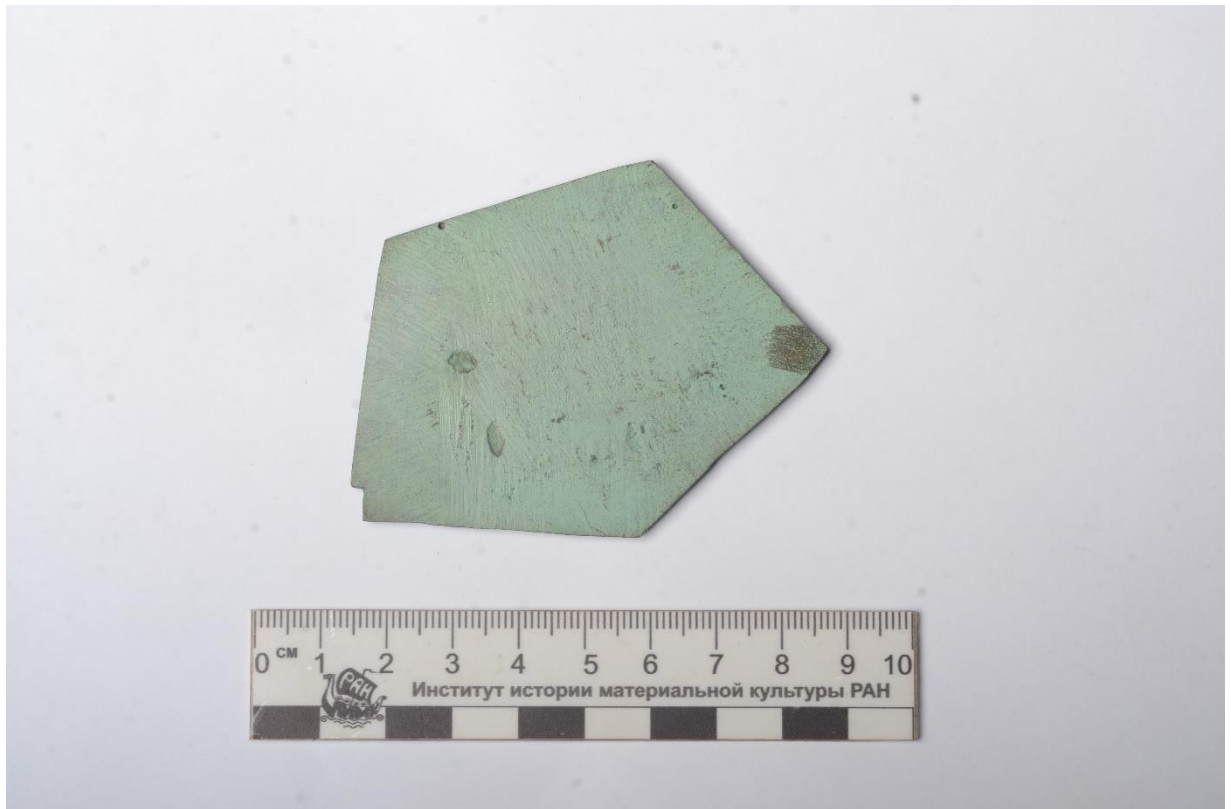
Рис. 37. Образец №3 искусственного патинирования химическим методом. После проведения испытания.
