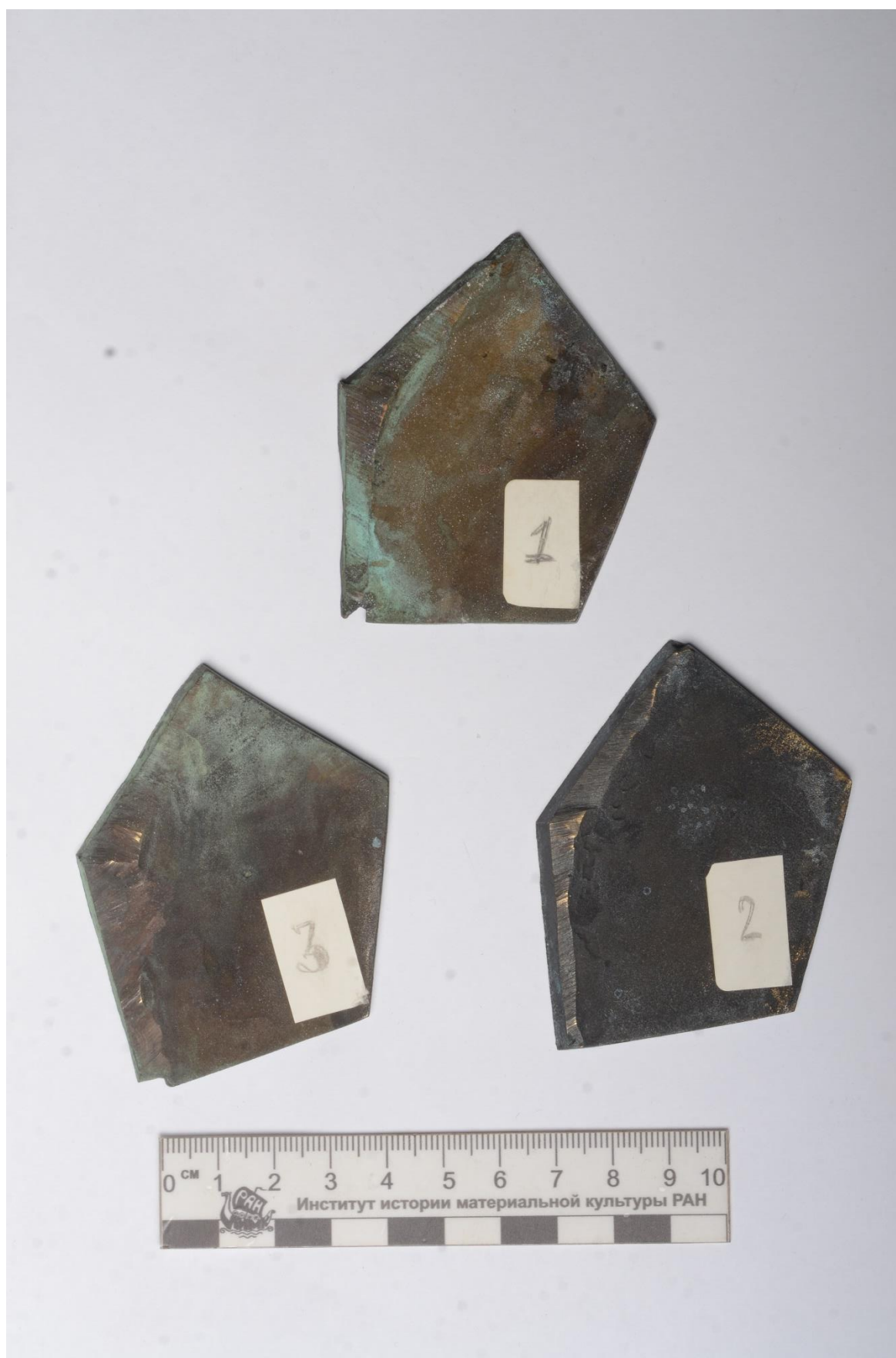
Рис. 34. Образцы, покрытые химическим методом искусственного патинирования. Обратная сторона. После проведения испытания.
