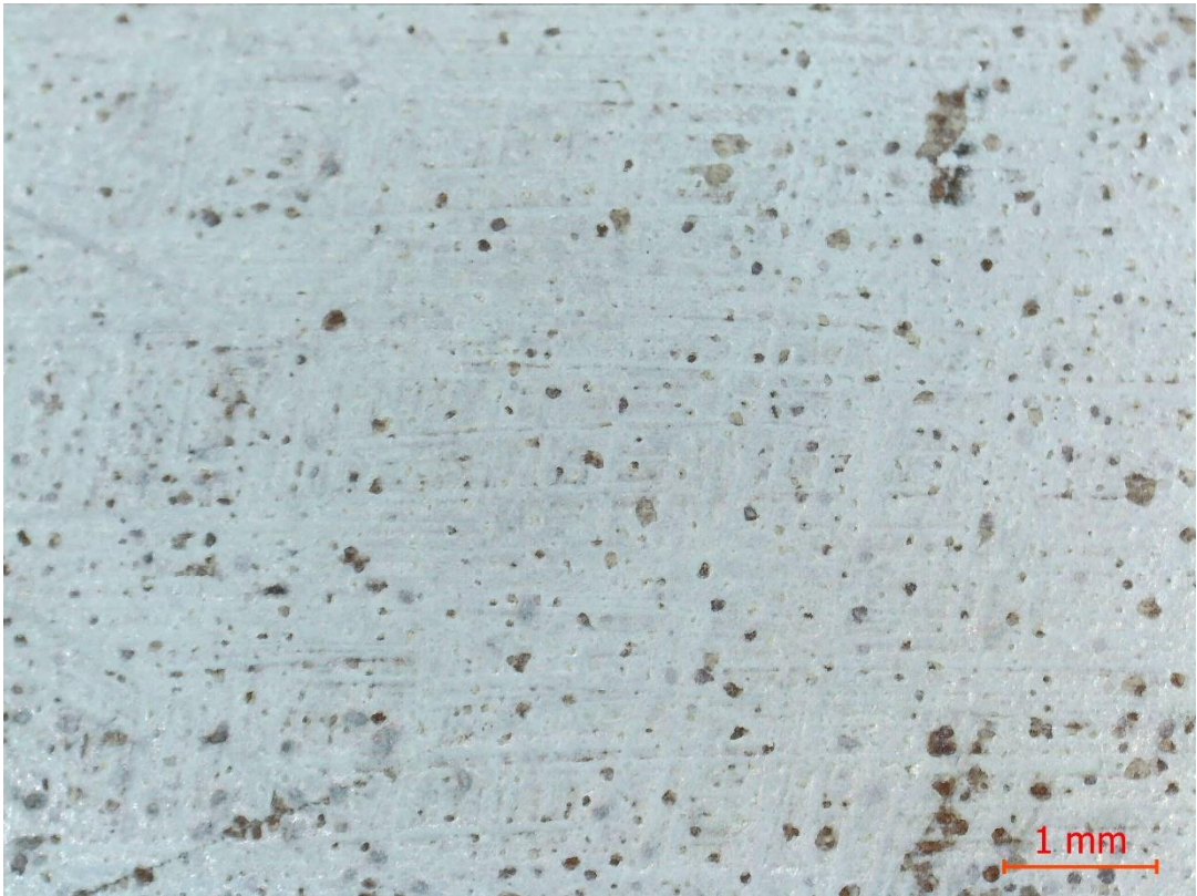
Рис. 63. Поверхность образца №3 искусственного патинирования химическим методом. После проведения испытания.
