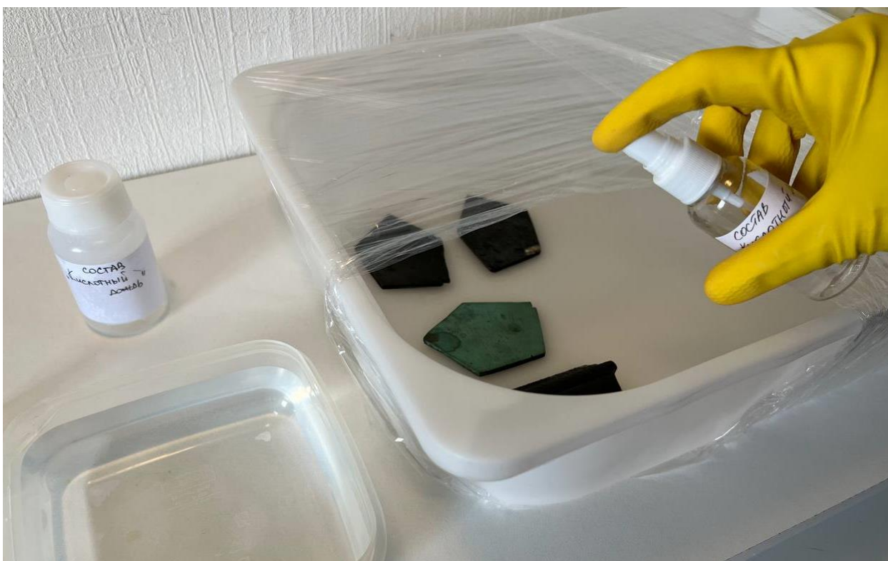
Рис. 31. Распыление состава «Кислотный дождь».
