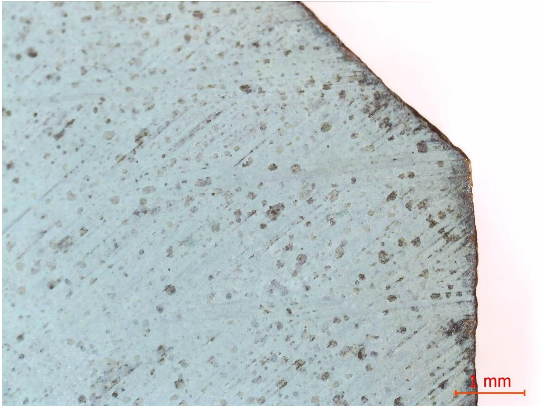
Рис. 97. Поверхность образца №3 искусственного патинирования химическим методом. После проведения испытания.
