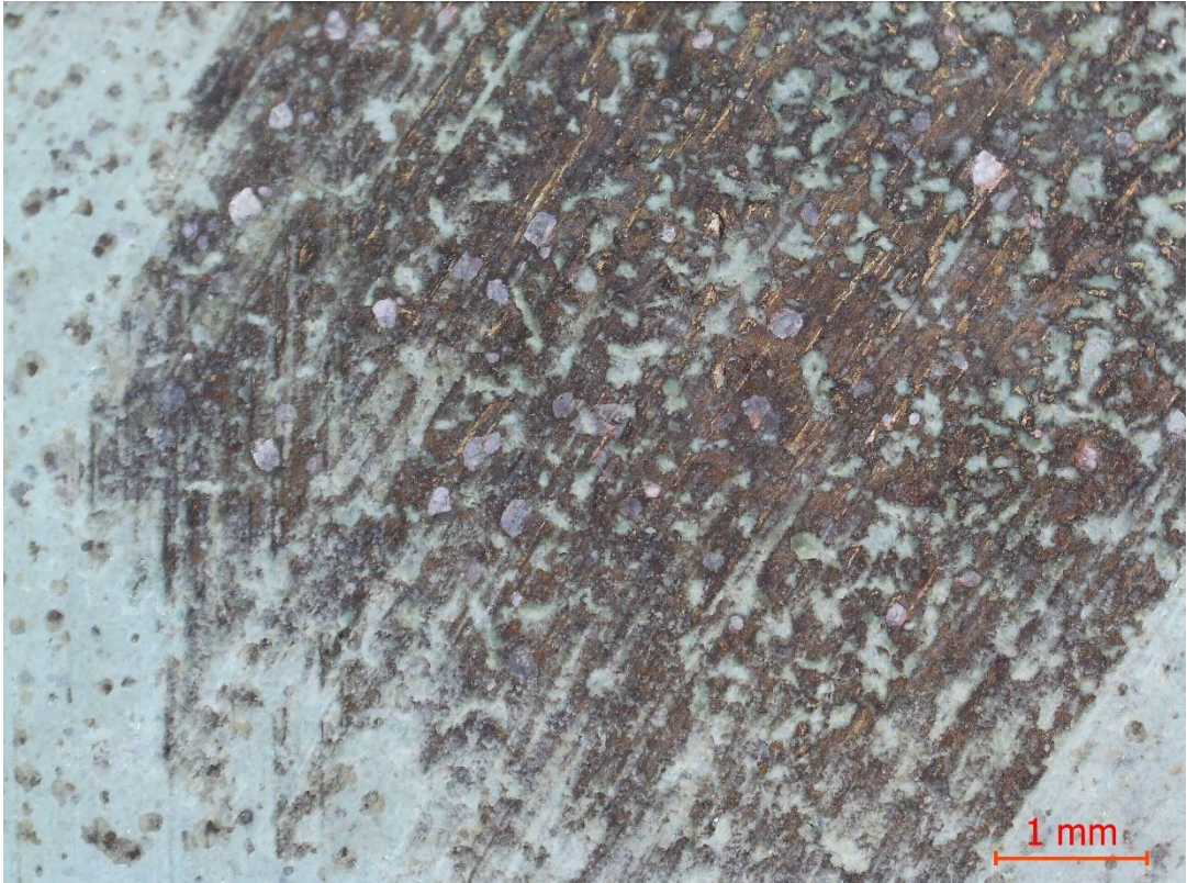
Рис. 64. Поверхность образца №3 искусственного патинирования химическим методом. После проведения испытания.
