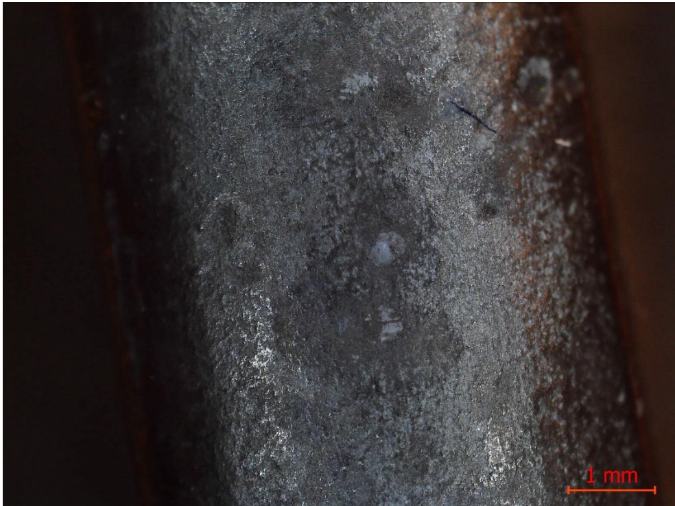
Рис. 75. Поверхность образца №4 искусственного патинирования методом холодного газодинамического напыления (ХГН). После проведения испытания.
