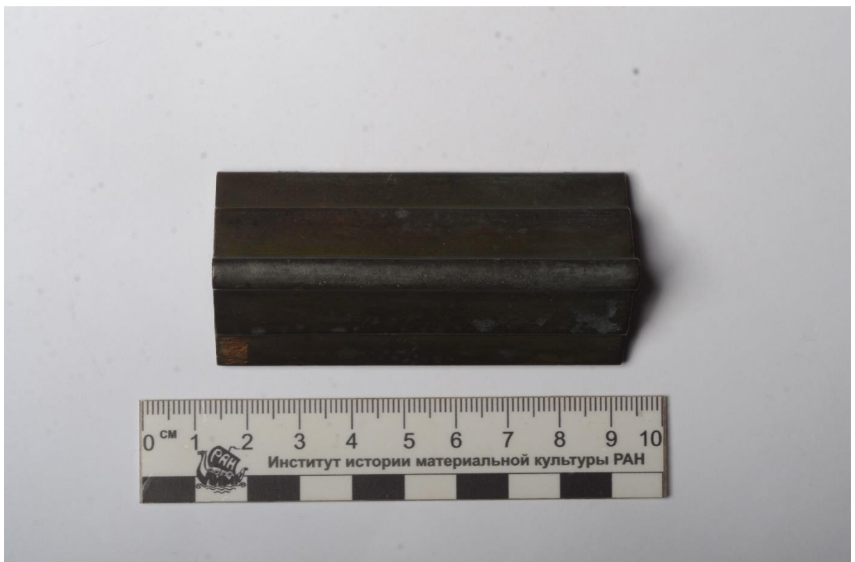
Рис. 38. Образец №4 искусственного патинирования методом холодного газодинамического напыления (ХГН). После проведения испытания.
