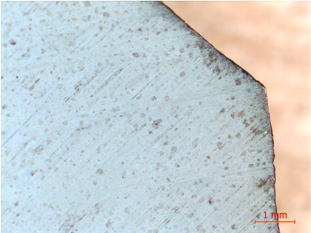
Рис. 96. Поверхность образца №3 искусственного патинирования химическим методом. До проведения испытания.
