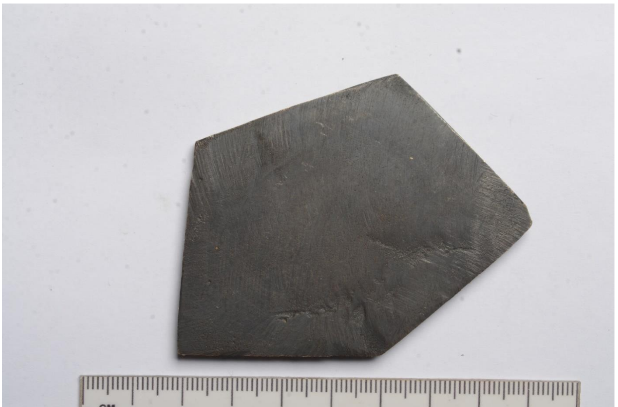
Рис. 3. Образец №2 искусственного патинирования химическим методом. До проведения испытания.
