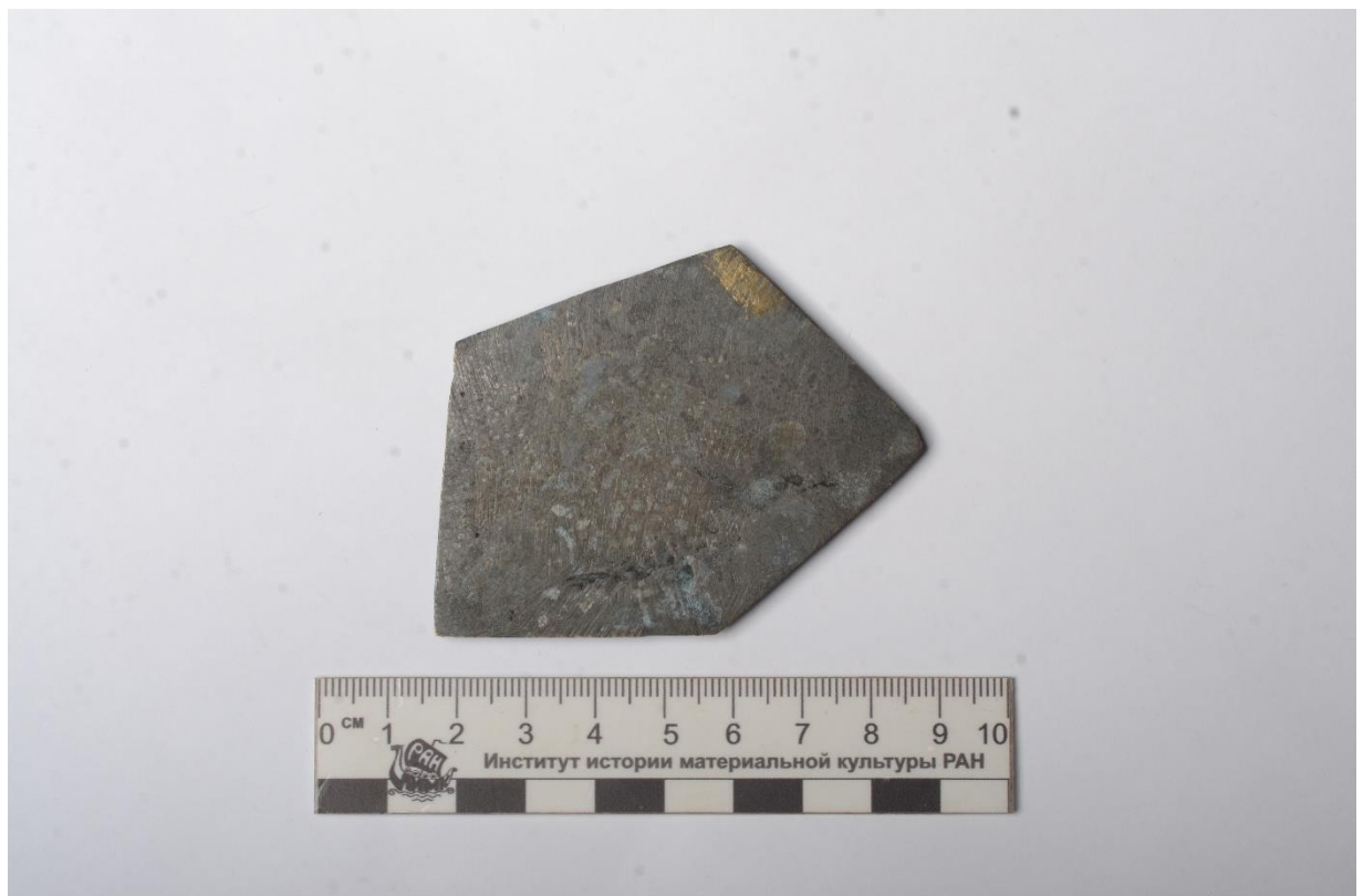
Рис. 36. Образец №2 искусственного патинирования химическим методом. После проведения испытания.
