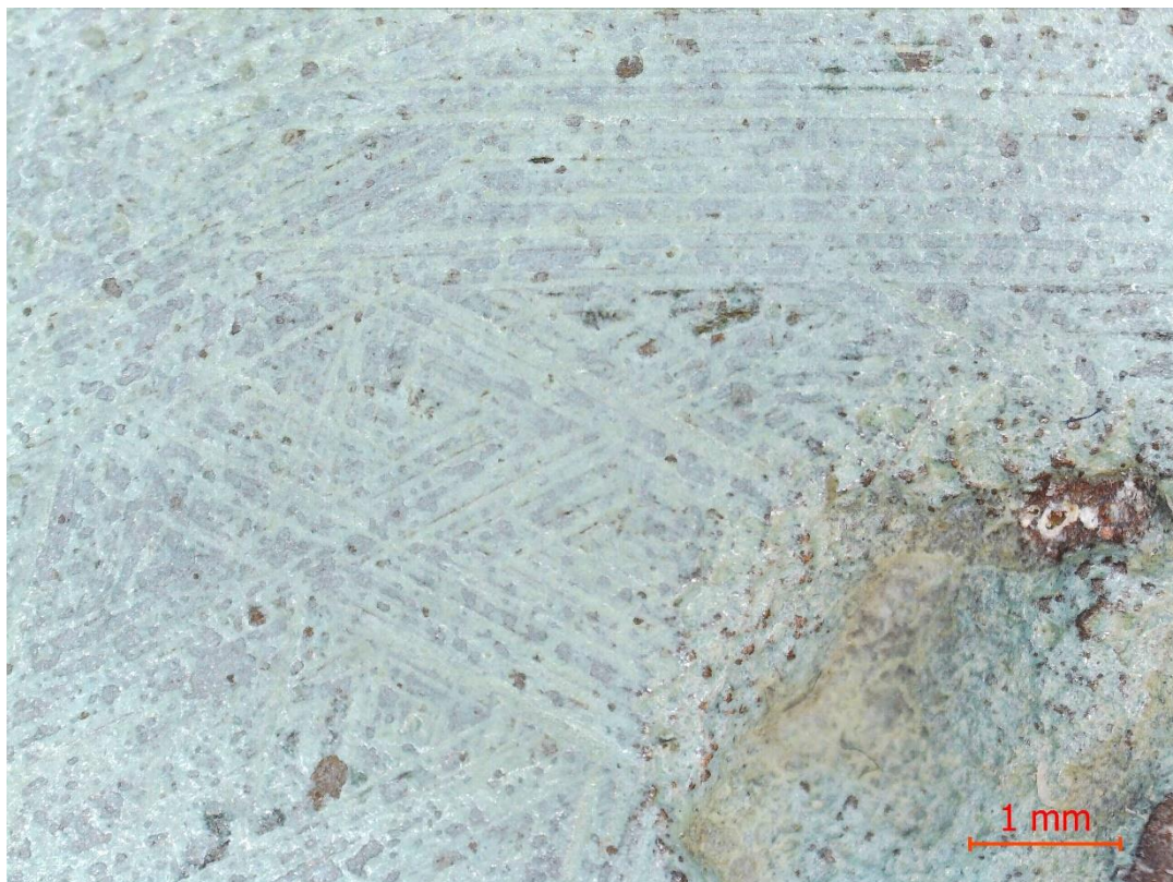
Рис. 90. Поверхность образца №3 искусственного патинирования химическим методом. До проведения испытания.
