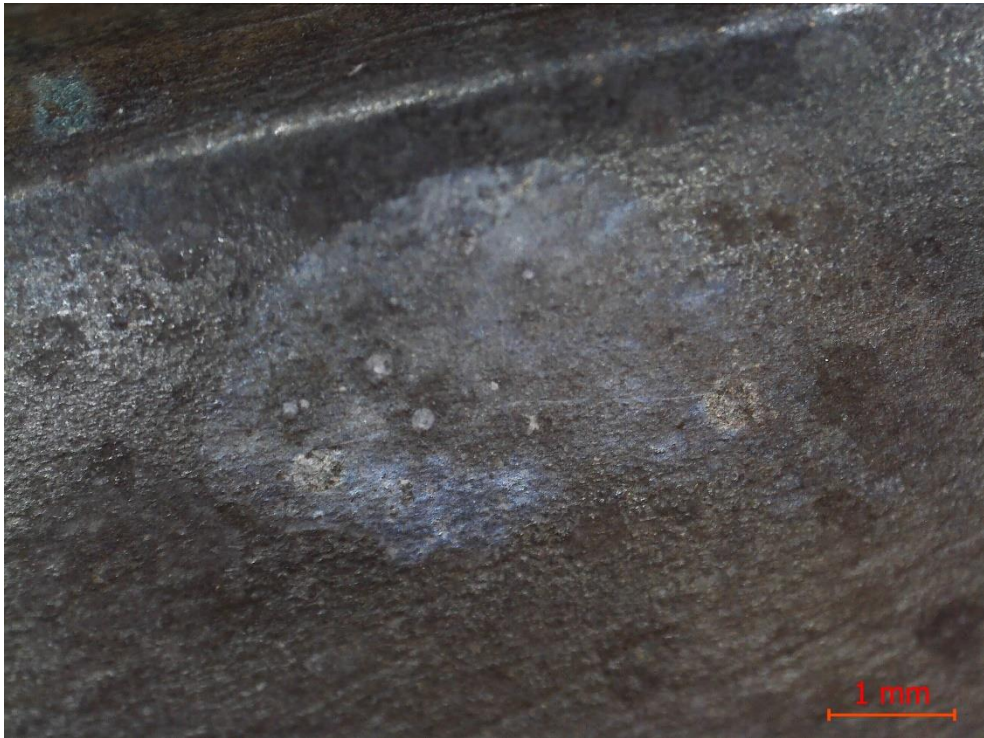
Рис. 67. Поверхность образца №4 искусственного патинирования методом холодного газодинамического напыления (ХГН). После проведения испытания.
