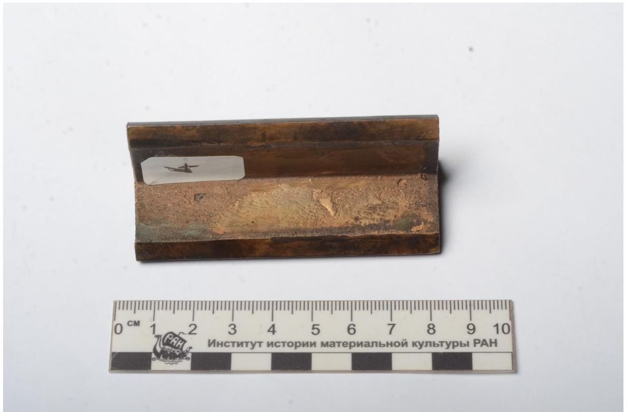
Рис. 39. Образец №4 искусственного патинирования методом холодного газодинамического напыления (ХГН). После проведения испытания.
