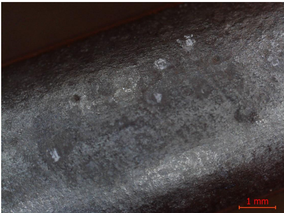
Рис. 87. Поверхность образца №4 искусственного патинирования методом холодного газодинамического напыления (ХГН). После проведения испытания.
