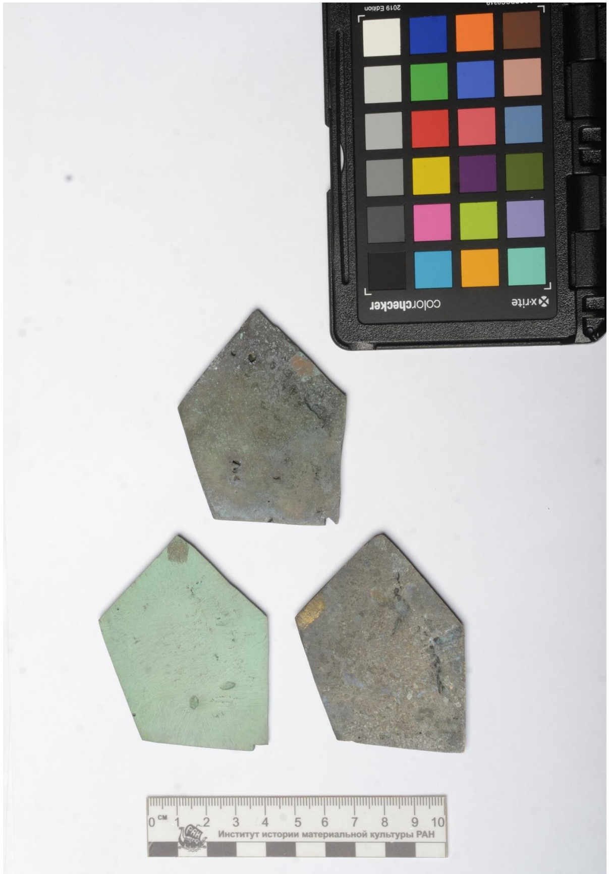
Рис. 33. Образцы, покрытые химическим методом искусственного патинирования. После проведения испытания.
