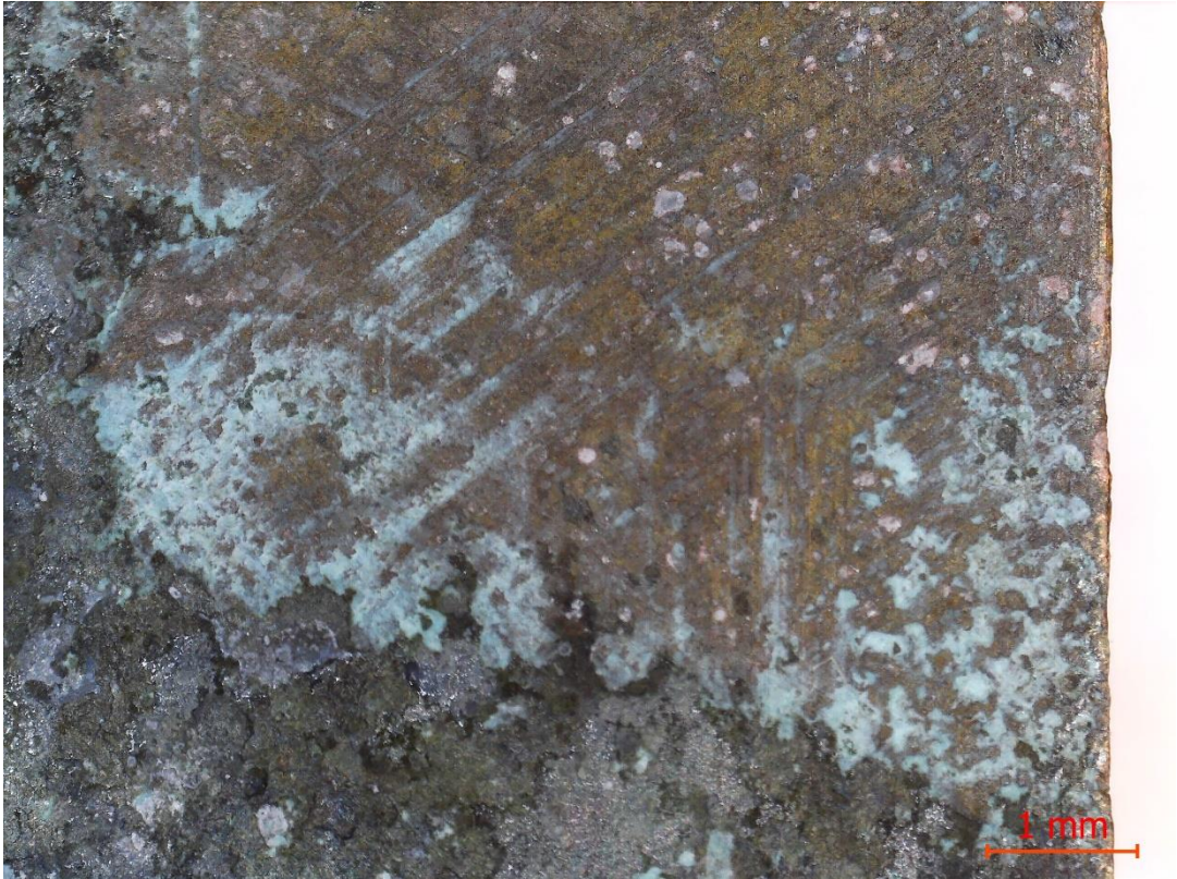
Рис. 48. Поверхность образца №1 искусственного патинирования химическим методом. После проведения испытания.
