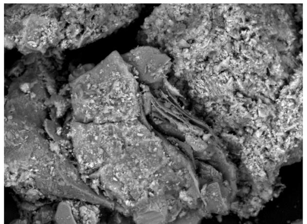
Рисунок 42. СЭМ-снимки загрязненного песка (увеличение x800)
