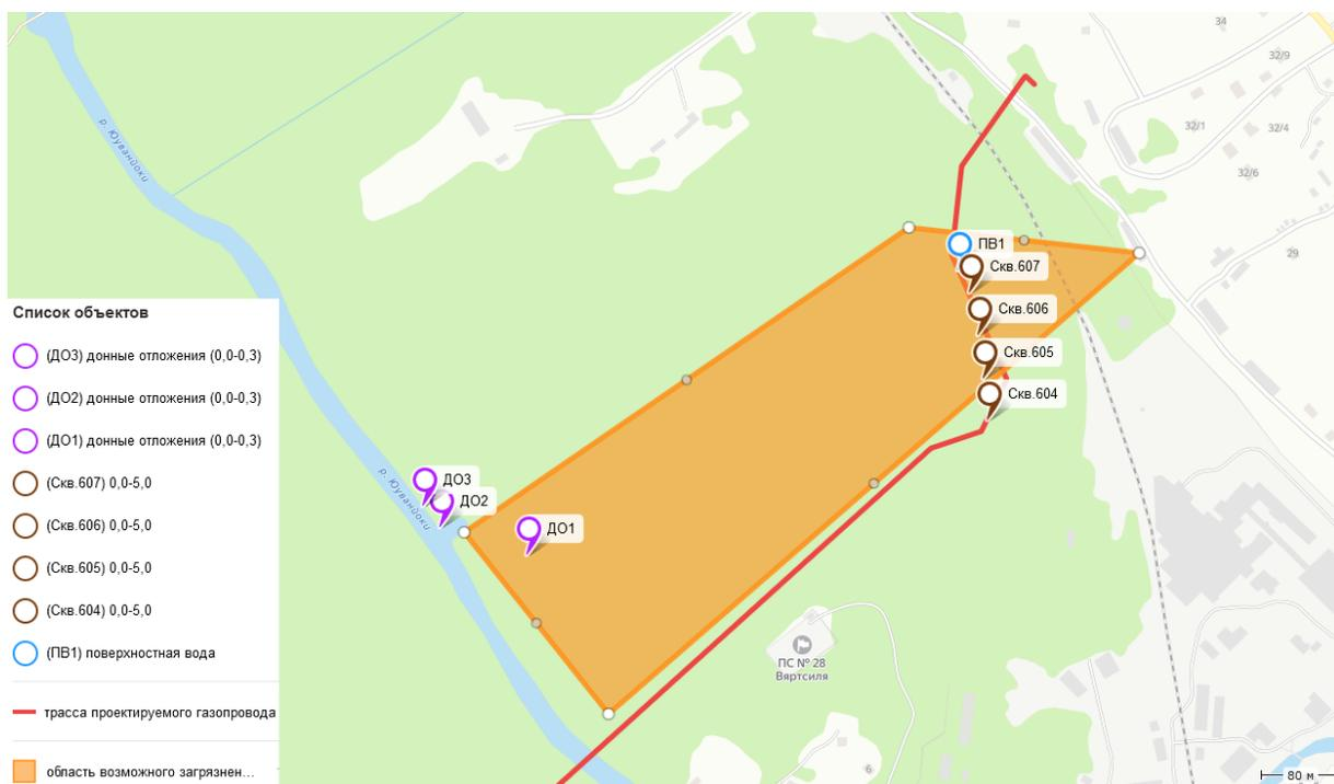
Рисунок 17. Схема расположения области возможного загрязнения нефтепродуктами и точек отбора проб
