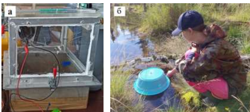
Рисунок 12 – Камера (а) для отбора и измерения проб метана (Ивахов и др., 2020) на озере (б) (фотография Ульяны Гусельниковой)
