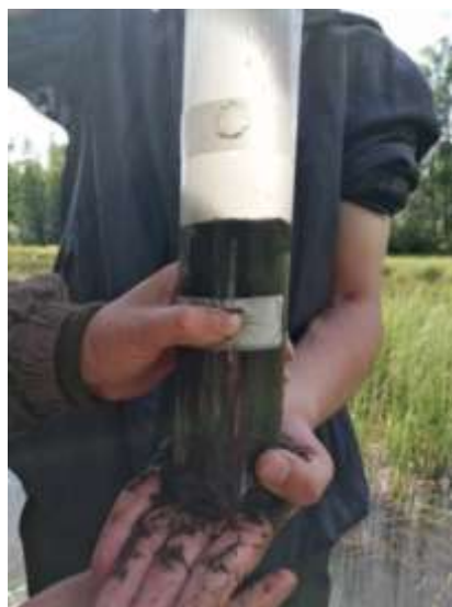
Рисунок 14 – Колонка донных отложений, оз. Гурокше-Нур (Республика Бурятия) с отверстиями для взятия проб (фотография Шорниковой Анны)
