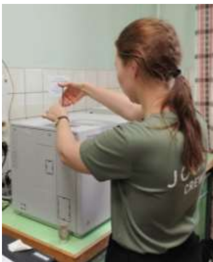
Рисунок 15 – Процесс ввода пара в испаритель хроматографа Хроматэк-Кристалл 5000 (фотография Климовой Анны, оборудование КарНЦ РАН)
