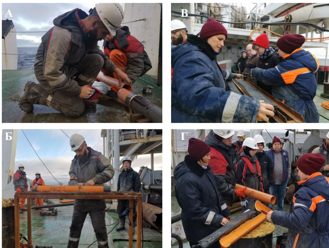
Рисунок 6. Процесс распила лайнеров: А – распил лайнеров по метровым секциям; Б – распил лайнеров вдоль; В-Г – обработка половинок секций перед транспортировкой в лаборатории
