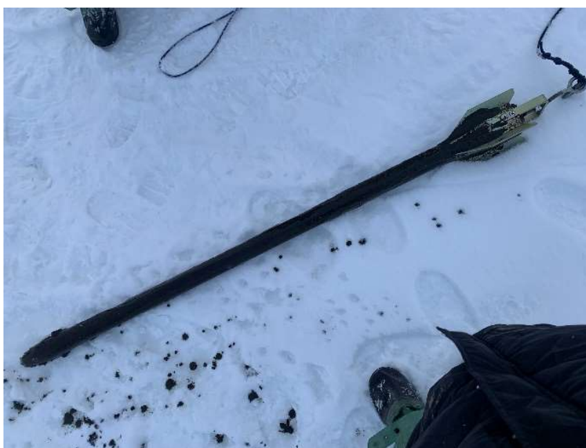
Рисунок 11.. Пробоотборник трубка ГОИН-1,5, фото автора
