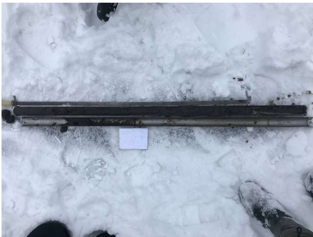
Рисунок 12. Отобранная при помощи ГОИН-1,5 колонка донных отложений.
