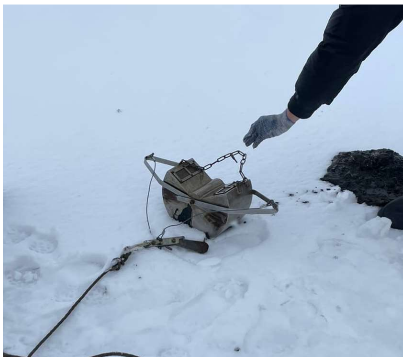
Рисунок 10. Бентосный дночерпатель Ван-Вина, фото автора
