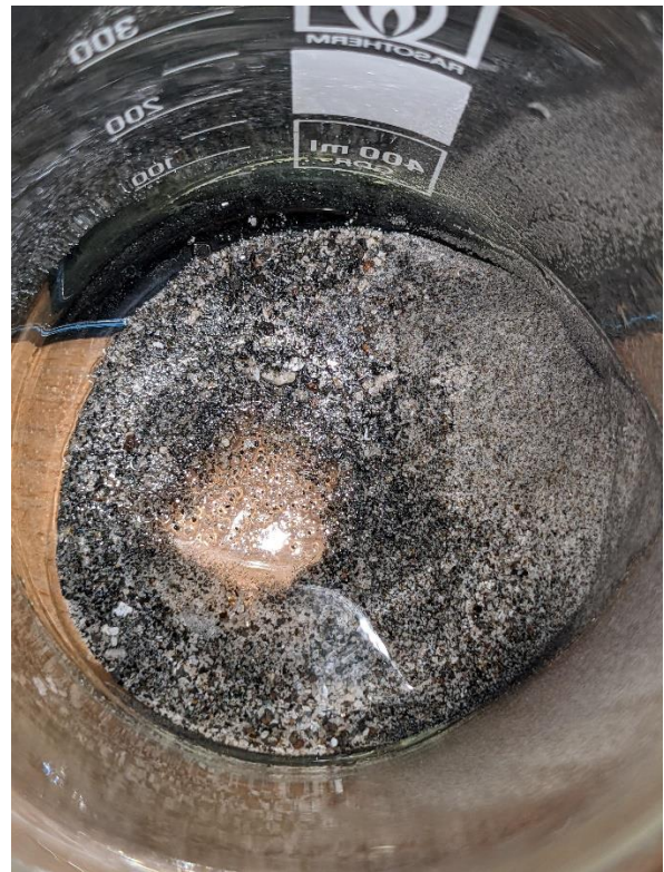
Рисунок 15. Процесс отмучивания от начала заливания туфа водой (1) до получения твёрдого остатка (6). Отмучивание выполнял: Бессмертный К.Н.
