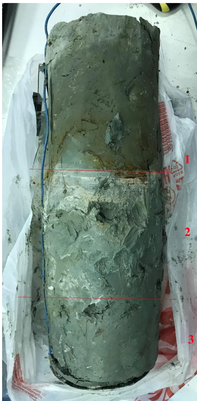
Рисунок 12. Монолит кембрийской глины после поляризации. Снизу - катод, сверху - анод.
