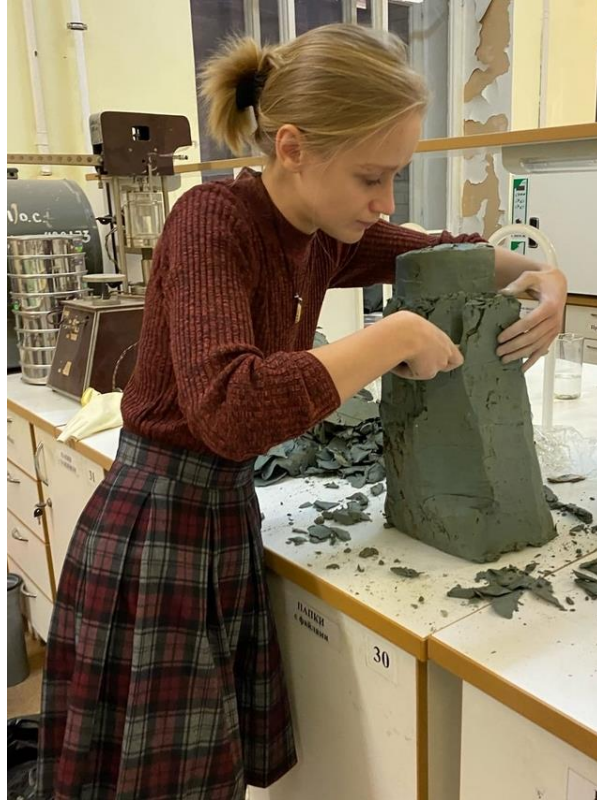
Рисунок 10. Процесс обработки цельного монолита кембрийской глины.
