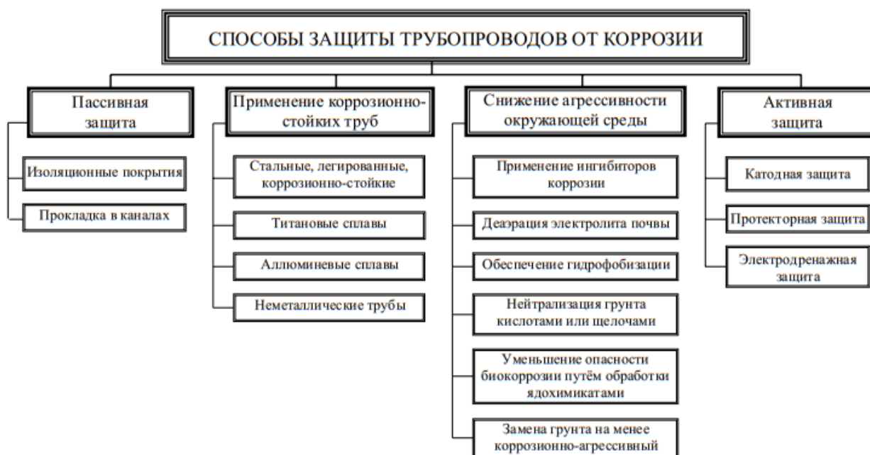
Рис. 3. Классификация способов защиты от подземной коррозии трубопроводов (Мустафин, 2003).
