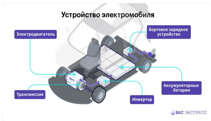
Рис. 3. Устройство электрического автомобиля (Источник: bes-express.ru)
