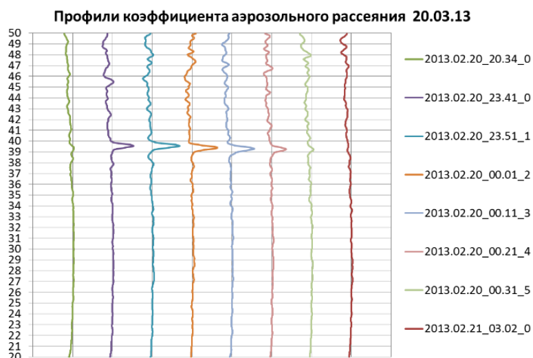
Рисунок 1 - Профили коэффициента аэрозольного рассеяния 20.03.13 по лидарным измерениям в Якутске. Вертикальные линии сетки соответствуют R=1 , и каждое измерение смещено на 1 для удобства восприятия
