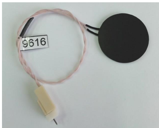
Рисунок 2 – Термопарный датчик теплового потока d = 27 мм
