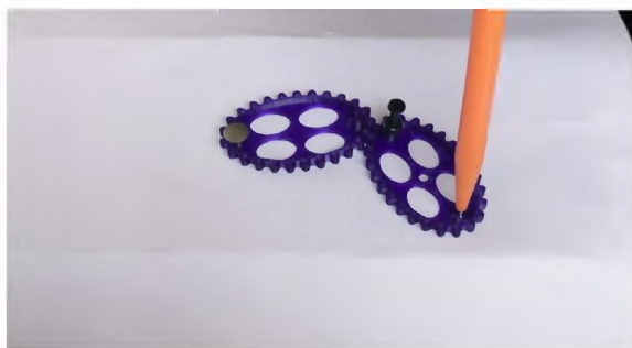
Рис. 5. Распечатанные на 3D-принтере модели эллиптических шестерней
