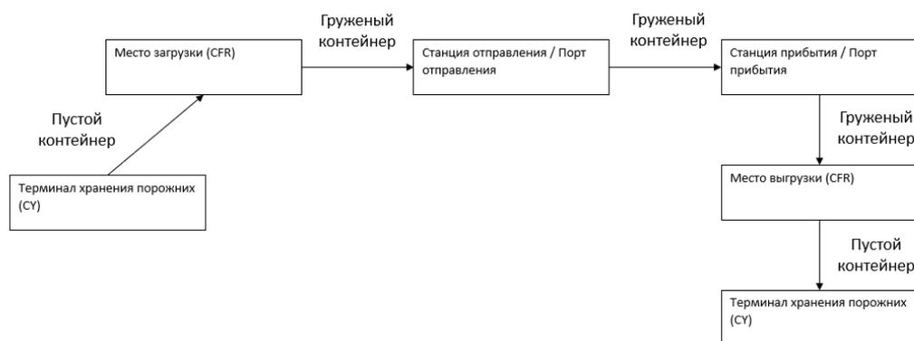
*Рис. 34. Упрощенная схема движения контейнера при выполнении перевозки*
