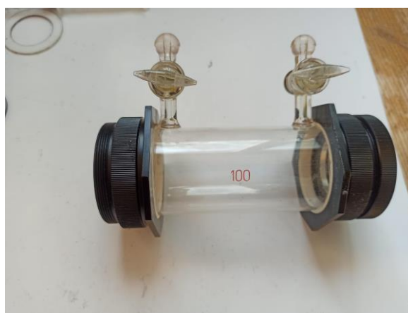
Рис 4. Кювета для исследования образцов в газовой фазе.
