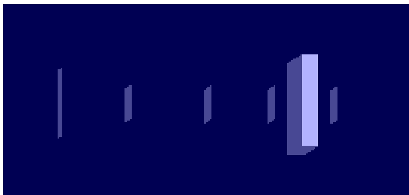
Рисунок 29 - третья конфигурация, состоящая из алюминиевой фольги, четырех детекторов и свинцовой пластины (между третьим и четвертым детектором)
