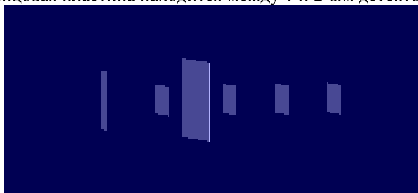
Рисунок 21 - первая конфигурация установки, состоящая из алюминиевой фольги, четырех детекторов и свинцовой пластины (между первым и вторым детектором)
