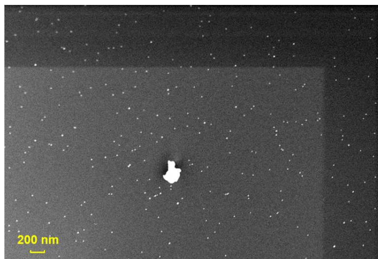
Рис. 38. СЭМ-снимок внутренней поверхности ПДАДМАХ-( uH3Z-BSA-1 ) модифицированного капилляра.
