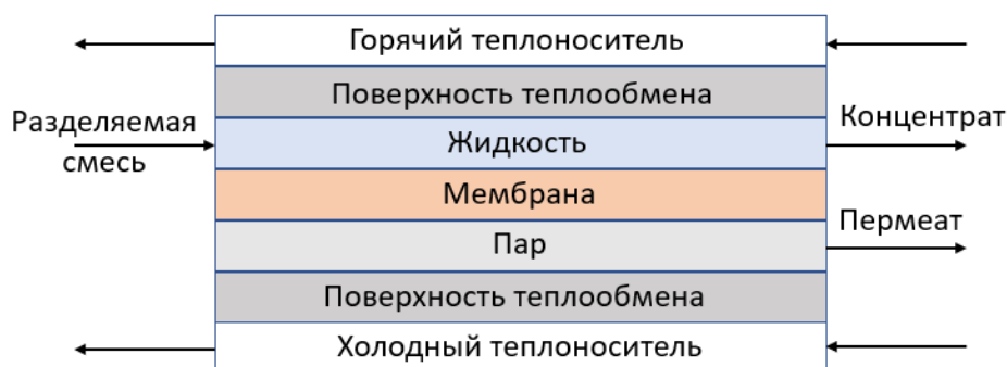
Рисунок 1.2. Схема процесса термопервапарации [34]
