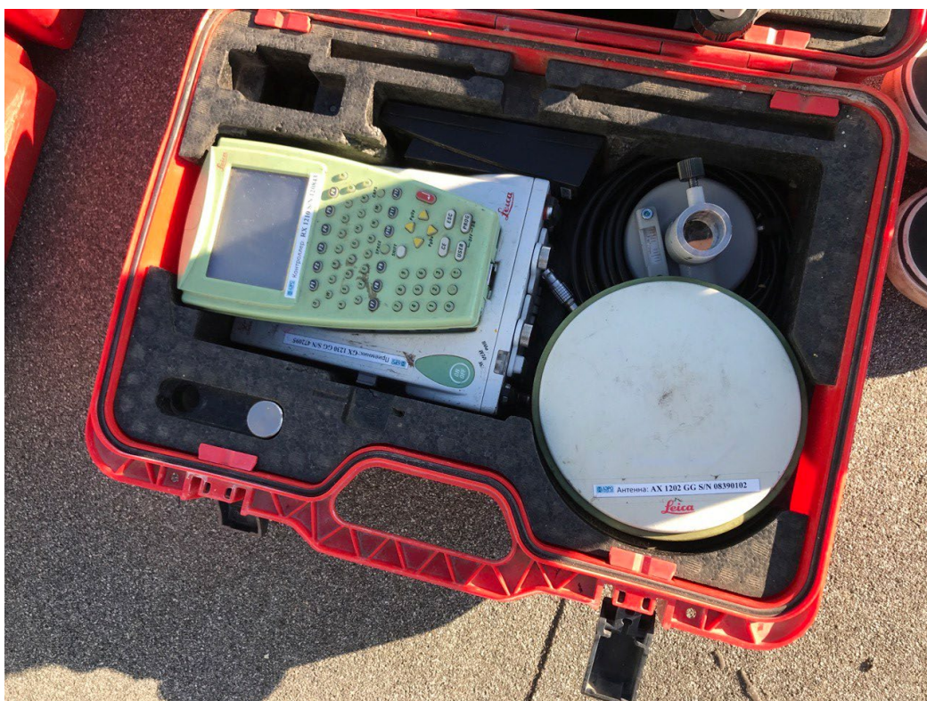
Рисунок 31 – Комплект Leica GX 1200GG
