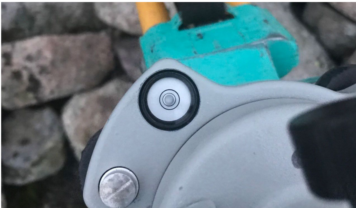
Рисунок 32 – Процесс центрирования и горизонтирования прибора
