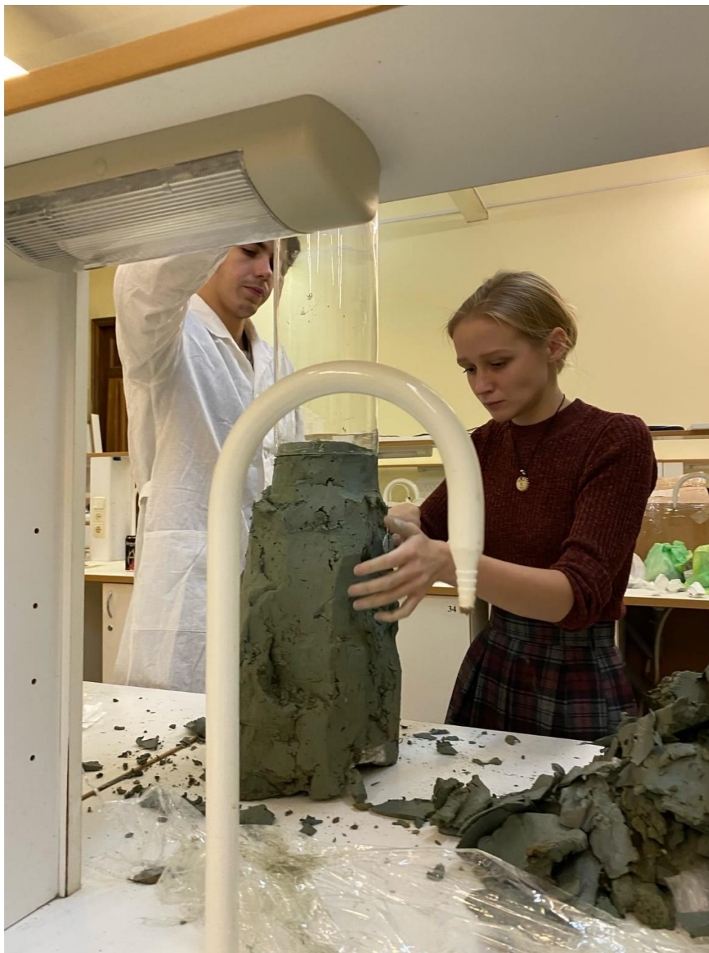
Рисунок 9. Подготовка монолита кембрийской глины для проведения физического моделирования.
