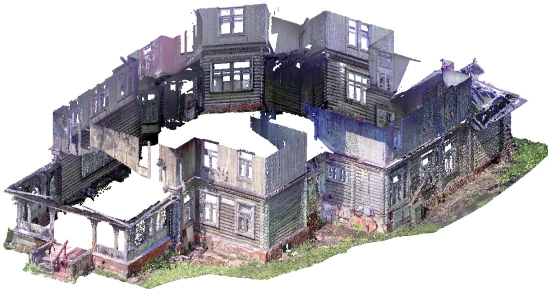
**Рис. 12:** Облако, полученное методом наземного лазерного сканирования для сравнения
