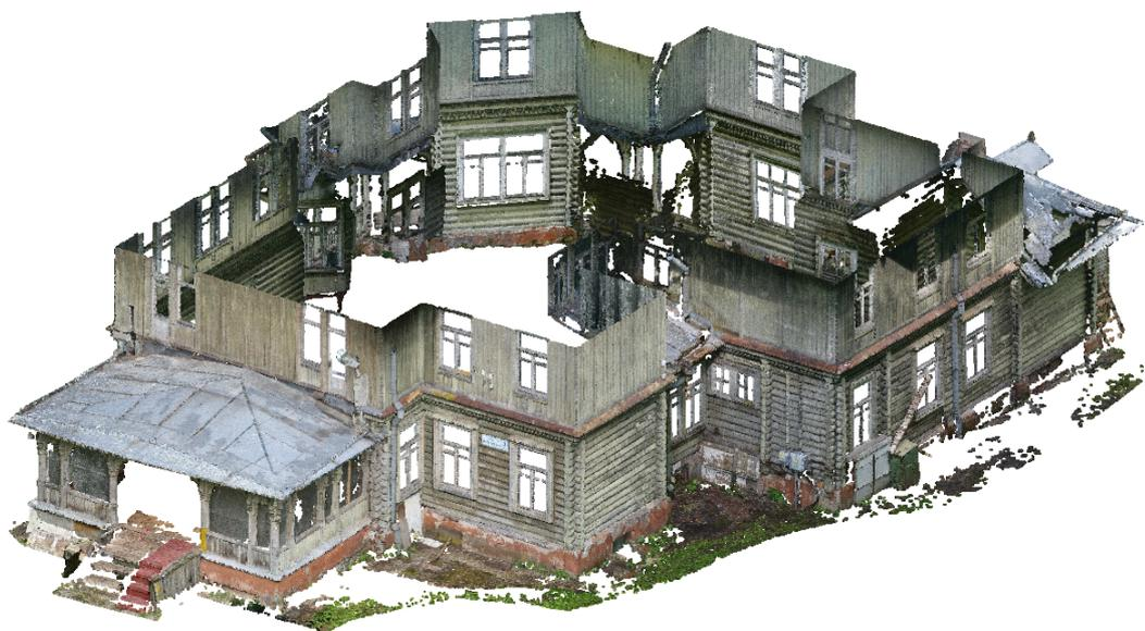
**Рис. 13:** Облако, полученное методом цифровой фотограмметрии для сравнения
