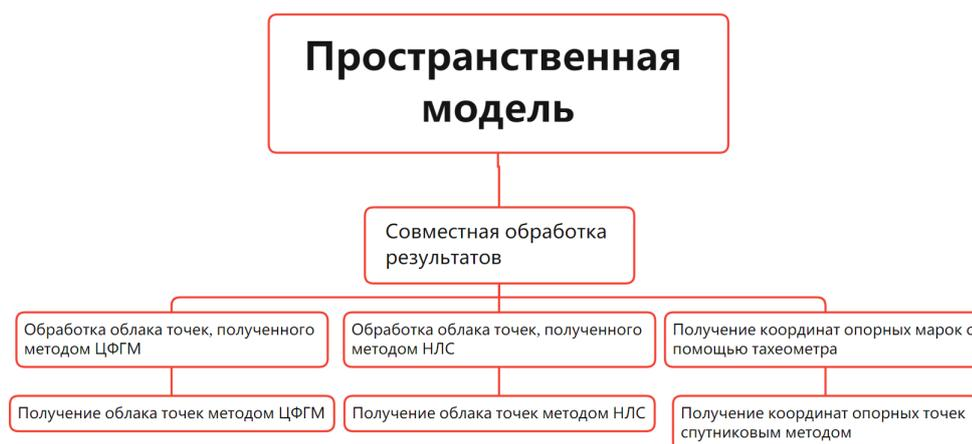
**Рис. 11:** Технологическая схема создания пространственной модели
