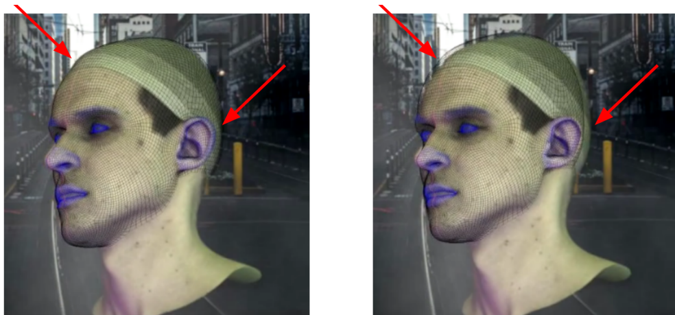
Рис. 9: Сравнение исходного алгоритма трекинга (слева) и описанной модификации (справа) на синтетическом тесте, кадр 10 из 80
