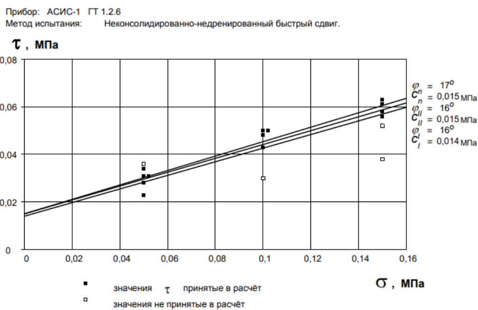
Рисунок 13 - График зависимости сопротивления срезам от нормального давления ИГЭ 4.
