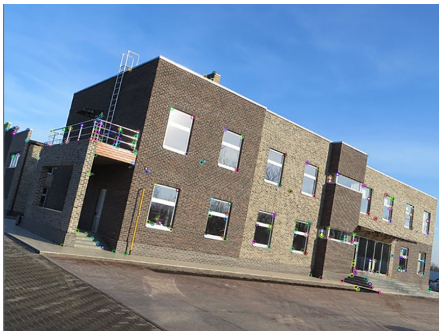
рис. 2.3.3. Особые точки, найденные методом FAST на повернутой фотографии.
