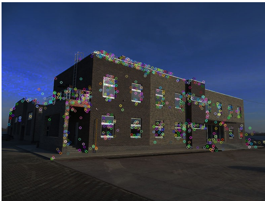
рис. 2.5.5. Особые точки, найденные методом SURF на затемнённой фотографии.
