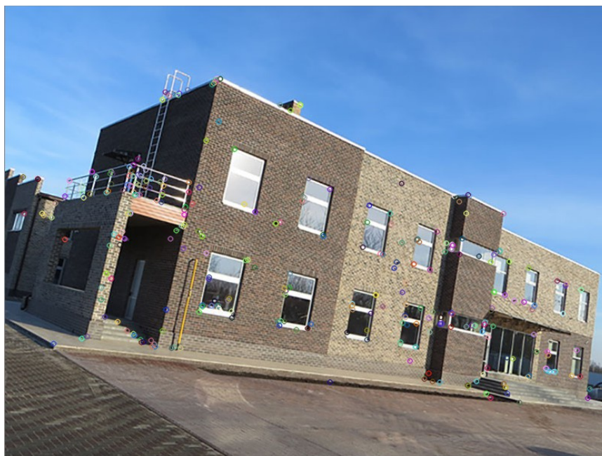
рис. 2.6.2. Особые точки, найденные методом BRISK на повернутой фотографии.
