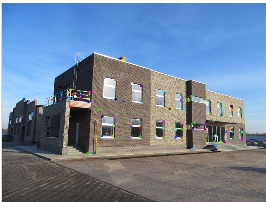
рис. 2.2.2. Особые точки, найденные методом Shi-Tomasi на фотографии здания.
