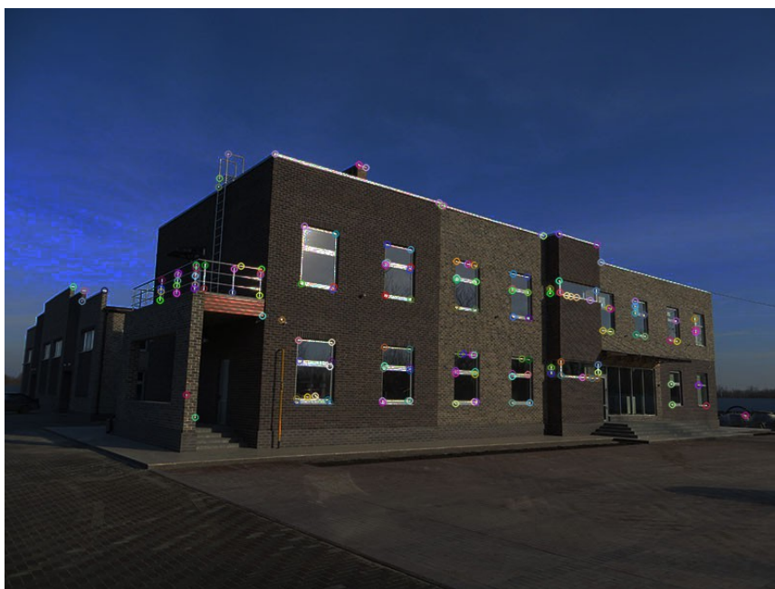
рис. 2.3.6. Особые точки, найденные методом FAST на затемнённой фотографии.
