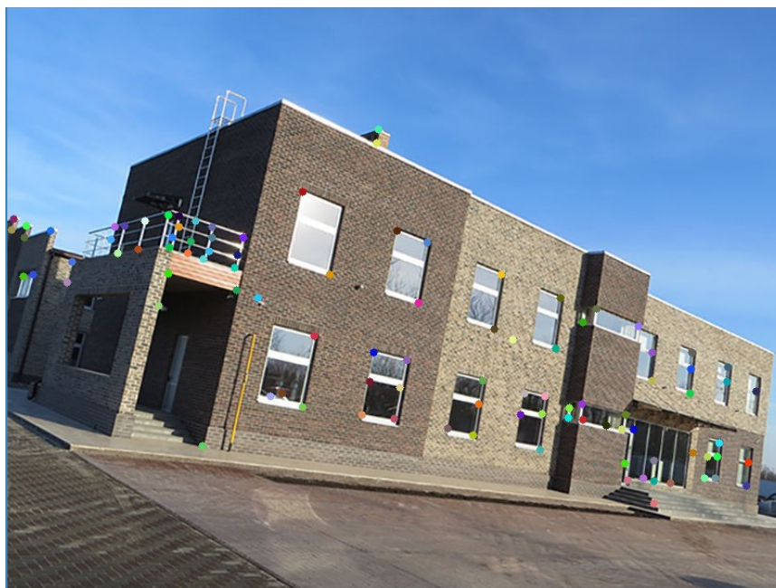
рис. 2.2.3. Особые точки, найденные методом Shi-Tomasi на повернутой фотографии.
