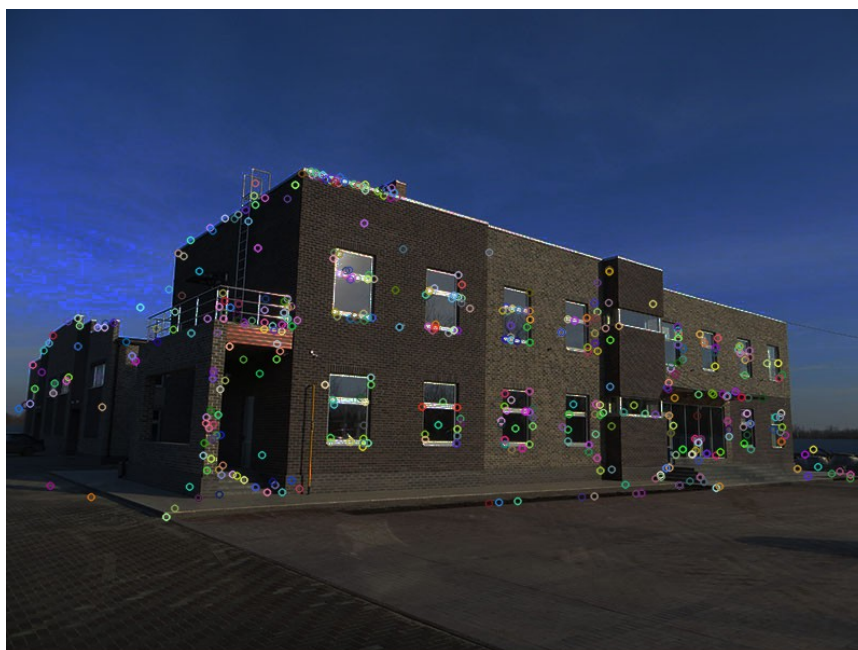
рис. 2.4.5. Особые точки, найденные методом SIFT на затемнённой фотографии.
