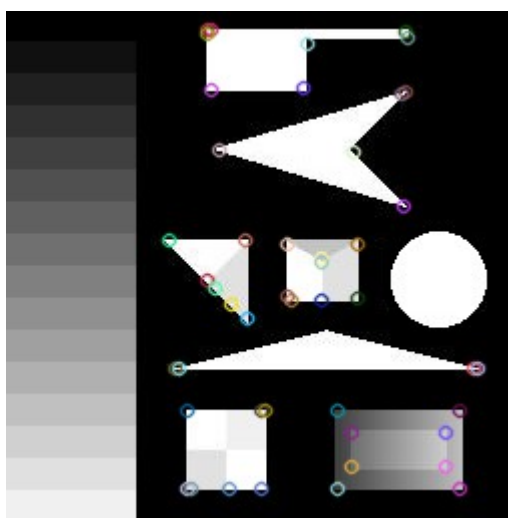
рис. 2.3.1. Особые точки, найденные методом FAST на тестовом изображении.
