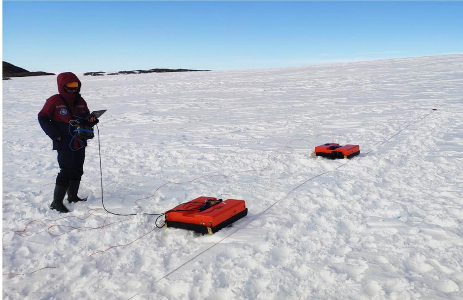
Рис. 8: Съёмка методом ОГТ.
