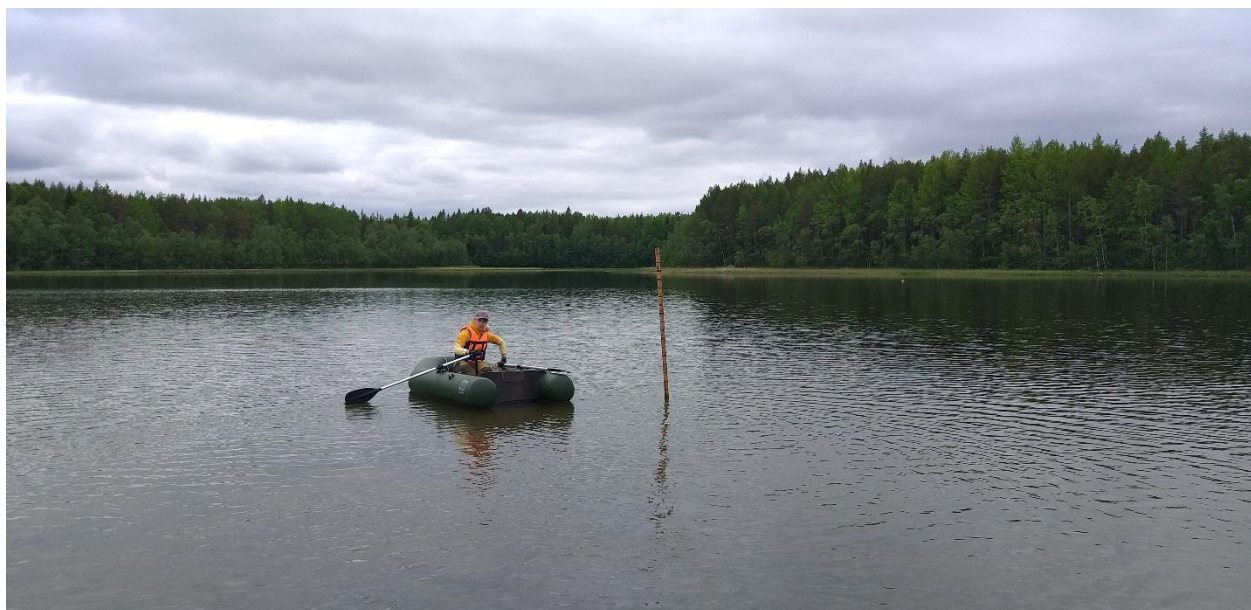
Рис. 2.3. Работы по измерению уровня воды и STD-зондированию в лагуне Колюшковая (20/06/2022).
