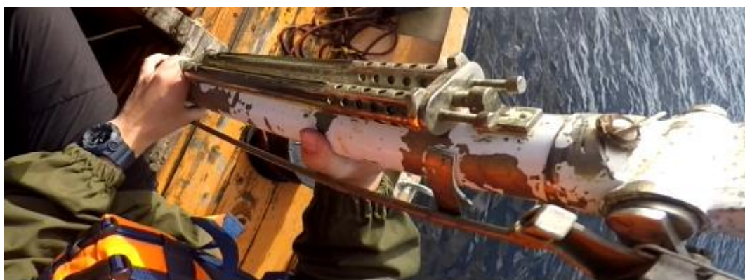
Рис. 2.6. Батометр Нансена БМ-48 с установленными глубоководными термометрами (фото от 23/06/2022).
