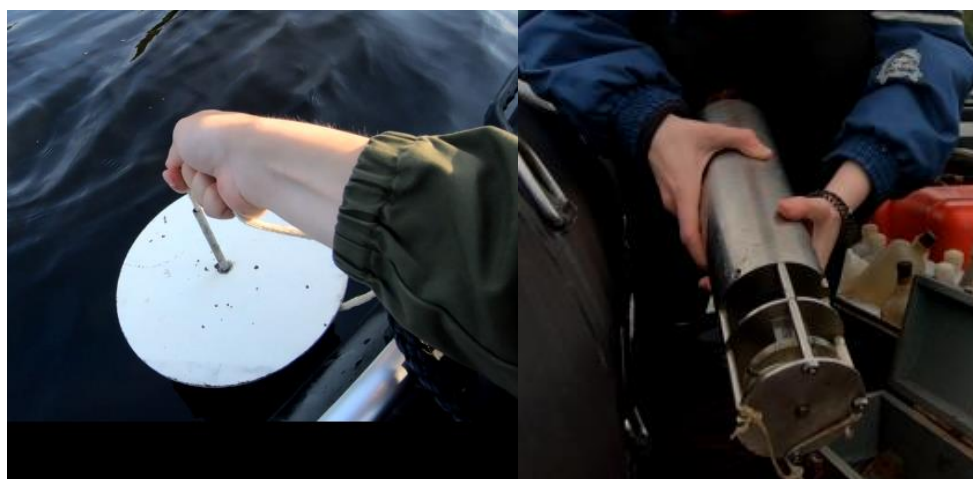
Рис. 2.4. Диск Секки (фото от 21/07/2022) (слева) и автономный измеритель течений «Вектор-2» (фото от 20/06/2022) (справа).
