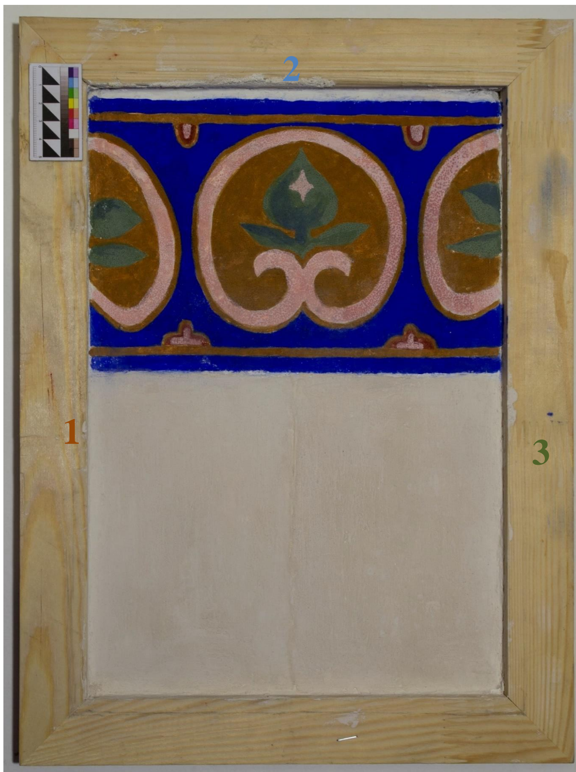
Рис. 3.2.6. Нанесен слой грунта под клеевую живопись на первый фрагмент образца. На третий фрагмент нанесен грунт под масляную живопись (перед нанесением грунта на образцах один и три нанесен слой проклейки). Прямое освещение.
