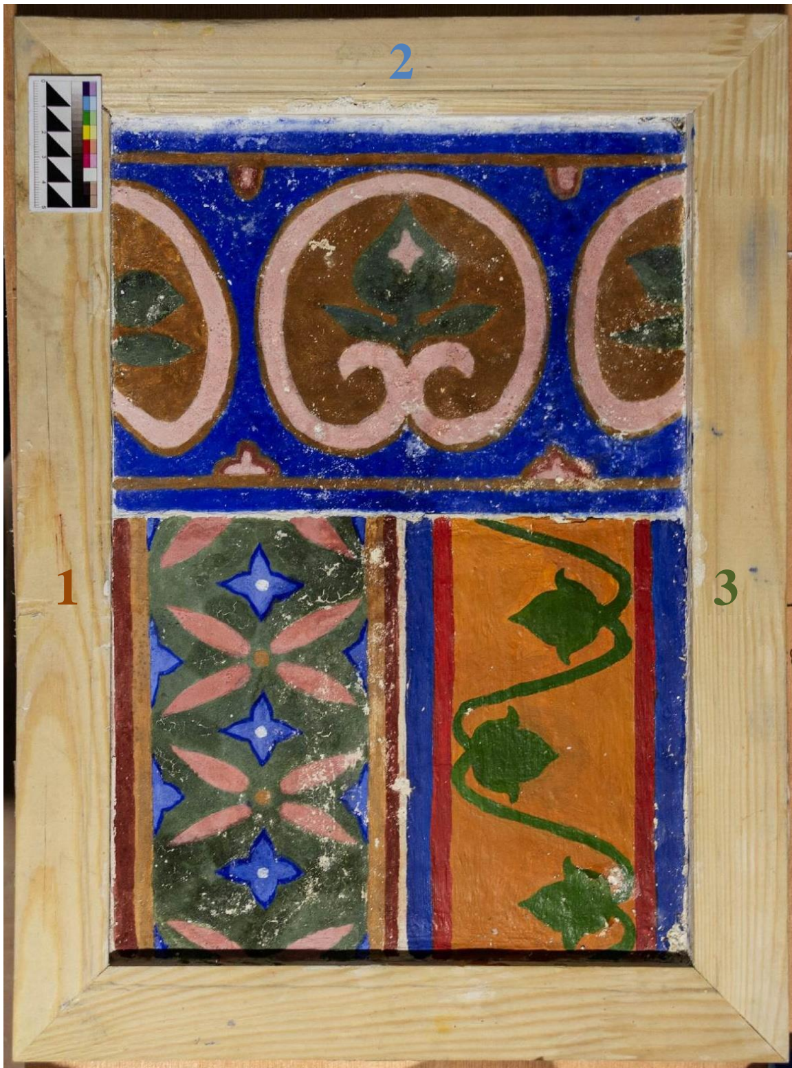
Рис. 3.2.16. Сразу после первого укрепления спиртовым раствором наноизвести Nanorestore Plus® Ethanol 5 фрагментов один и два (клеевой живописи и фрески). Прямое освещение.
