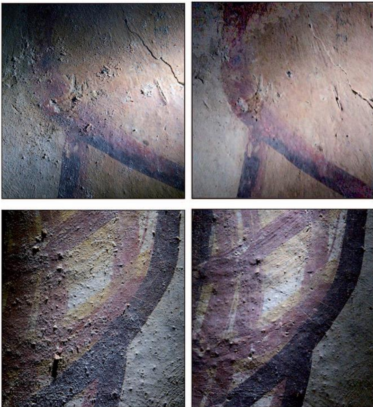
Рис.2.3.3. Фрагменты настенной росписи, представленные на рисунке 2.3.2. Изображения слева показывают наличие сульфатов на поверхности и шелушений красочного слоя; на фотографиях справа показаны те же самые фрагменты через шесть месяцев после нанесения дисперсии наночастиц гидроксида кальция и бария в спирте (1-пропанол).
