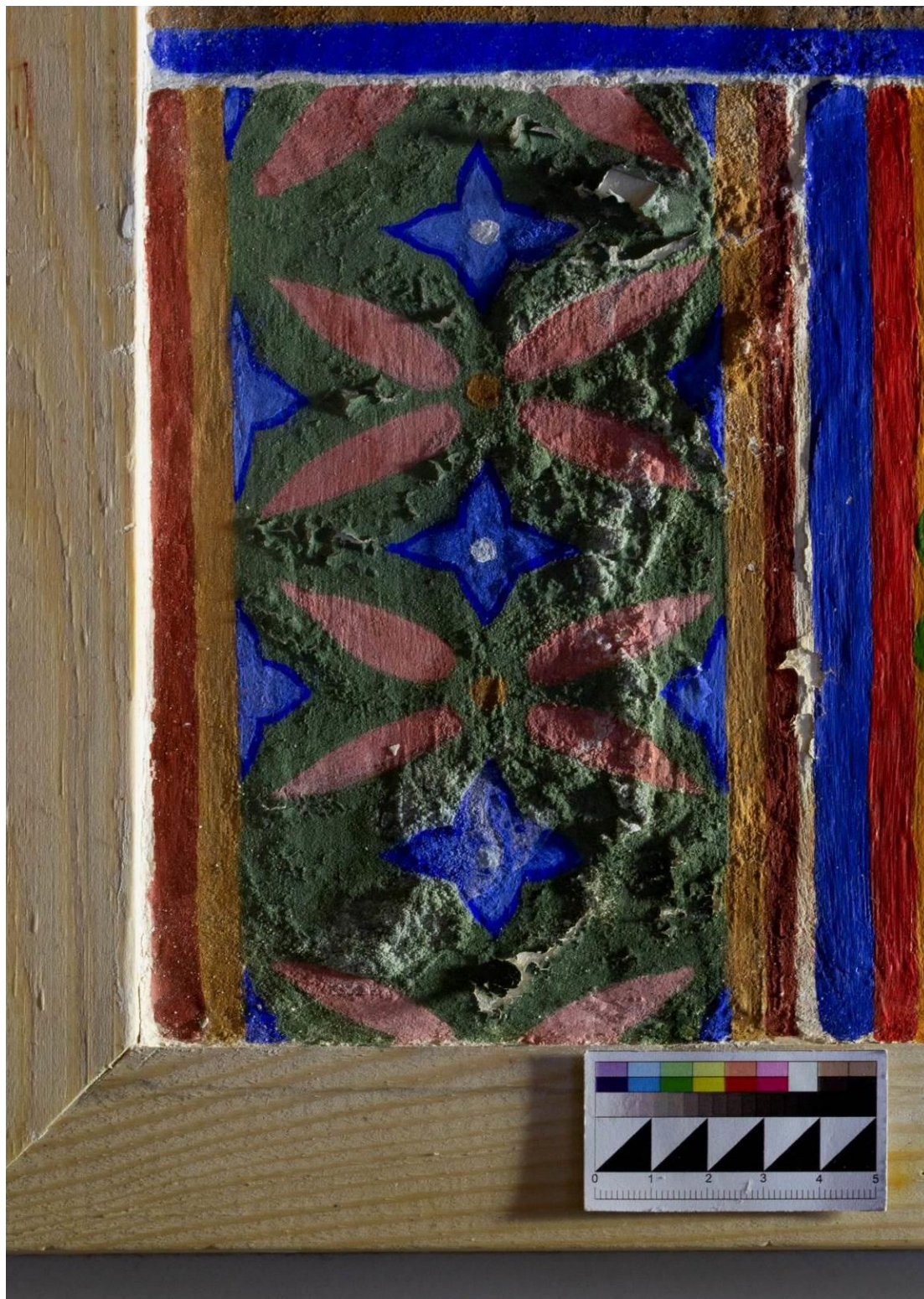
Рис. 3.2.20. После проведения второго цикла солеобразования. Боковое освещение.
