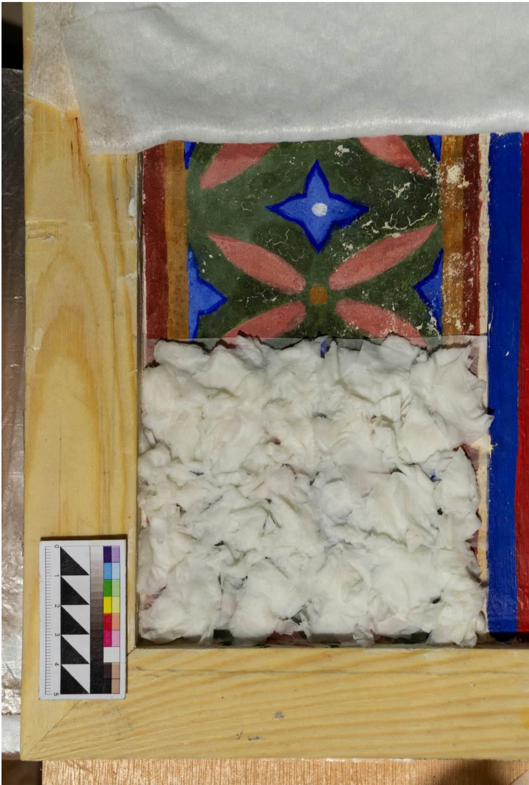
Рис. 3.2.24. После удаления солей из структуры живописи, в процессе первого укрепления спиртовым раствором наноизвестки Nanorestore Plus® Ethanol 5. Боковое освещение.
