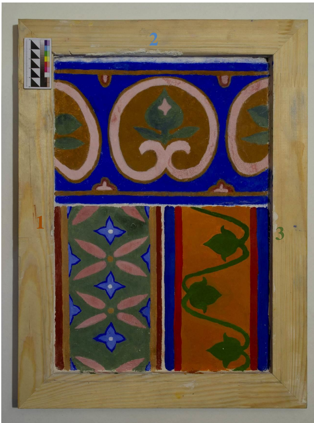
Рис. 3.2.7. На первом фрагменте образца выполнен красочный слой в технике клеевой живописи. На третьем фрагменте образца выполнен красочный слой в технике масляной живописи. Прямое освещение.
