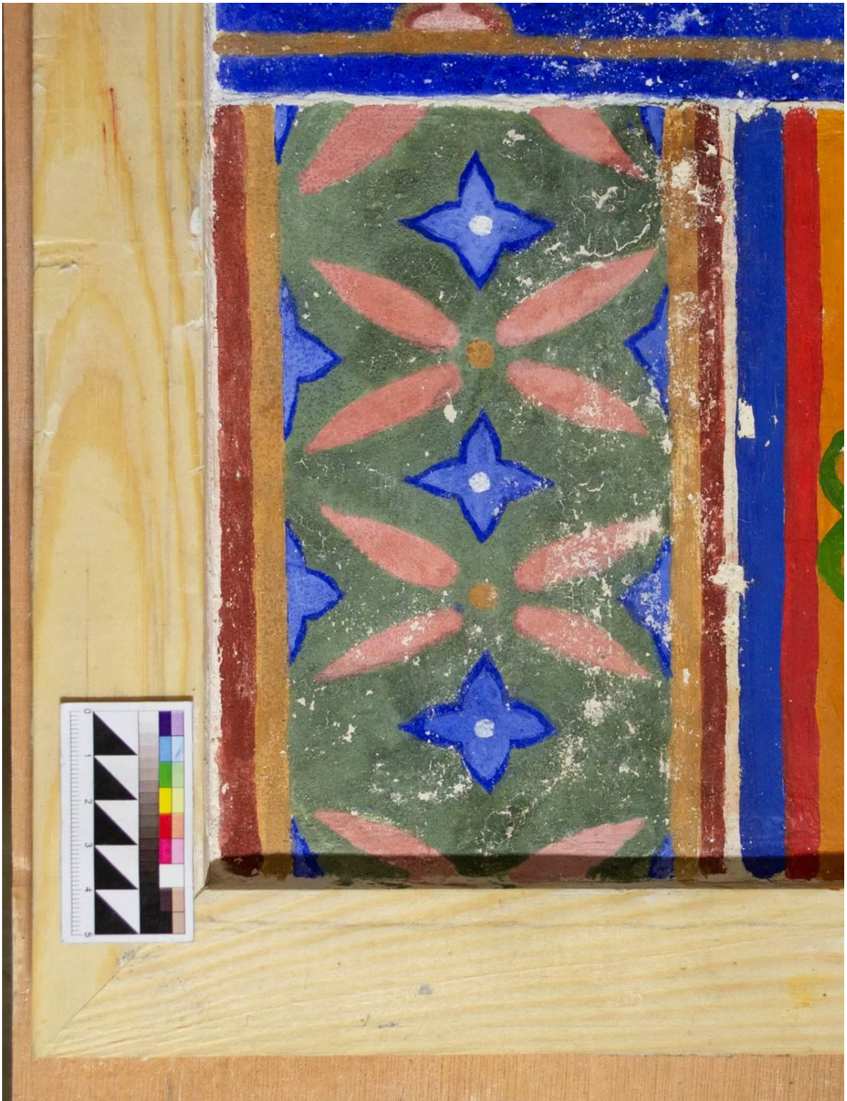
Рис. 3.2.28. После высыхания, после второго укрепления спиртовым раствором наноизвести Nanorestore Plus® Ethanol 5. Боковое освещение.
