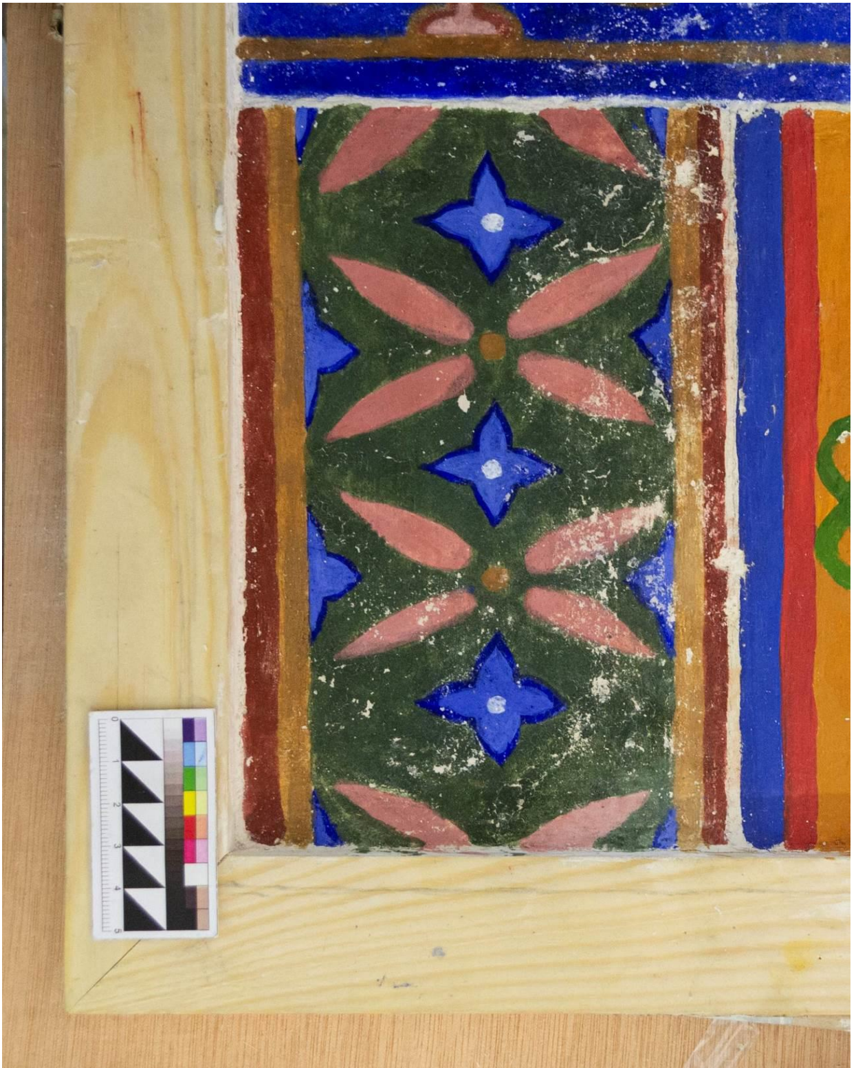
Рис. 3.2.27. Сразу после второго укрепления спиртовым раствором наноизвести Nanorestore Plus® Ethanol 5. Прямое освещение.
