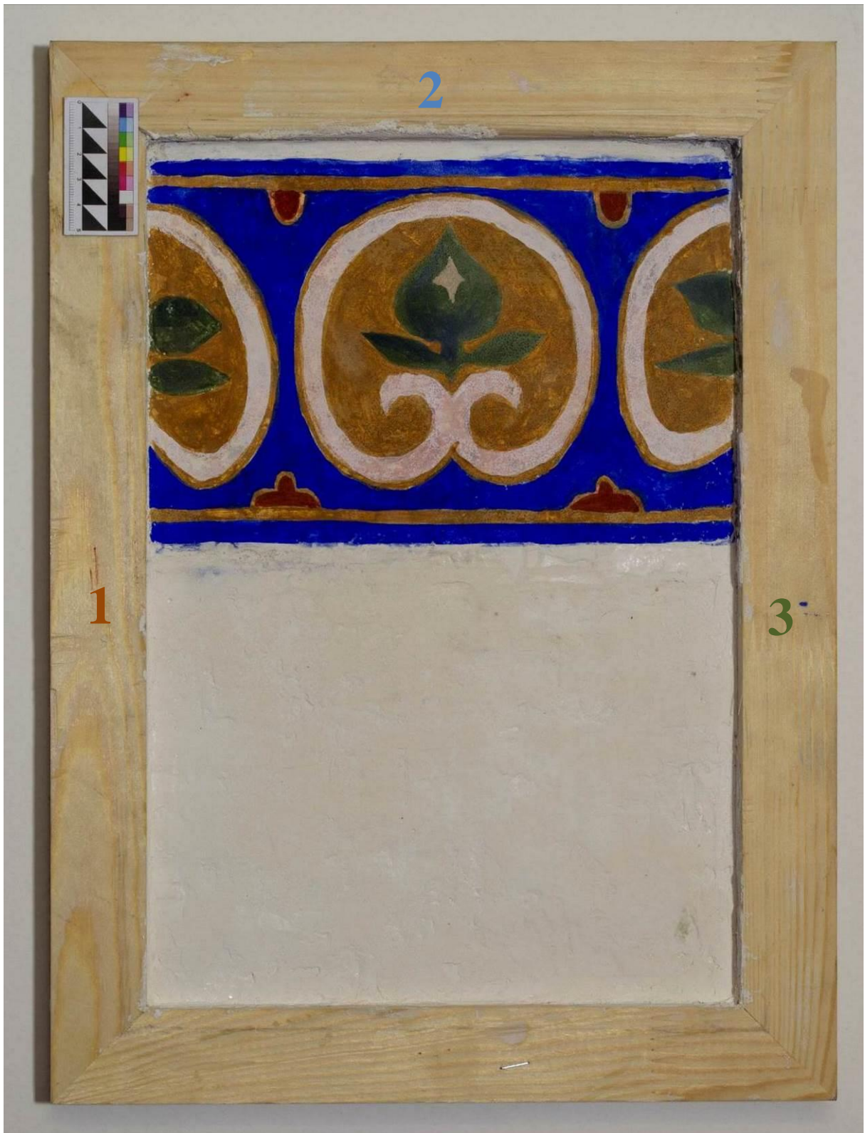
Рис. 3.2.5. Нанесен третий, тонкий слой штукатурки – накрывка. Выполнен красочный слой на втором фрагменте образца – в технике «buon fresco» («истинная» фреска). Прямое освещение.
