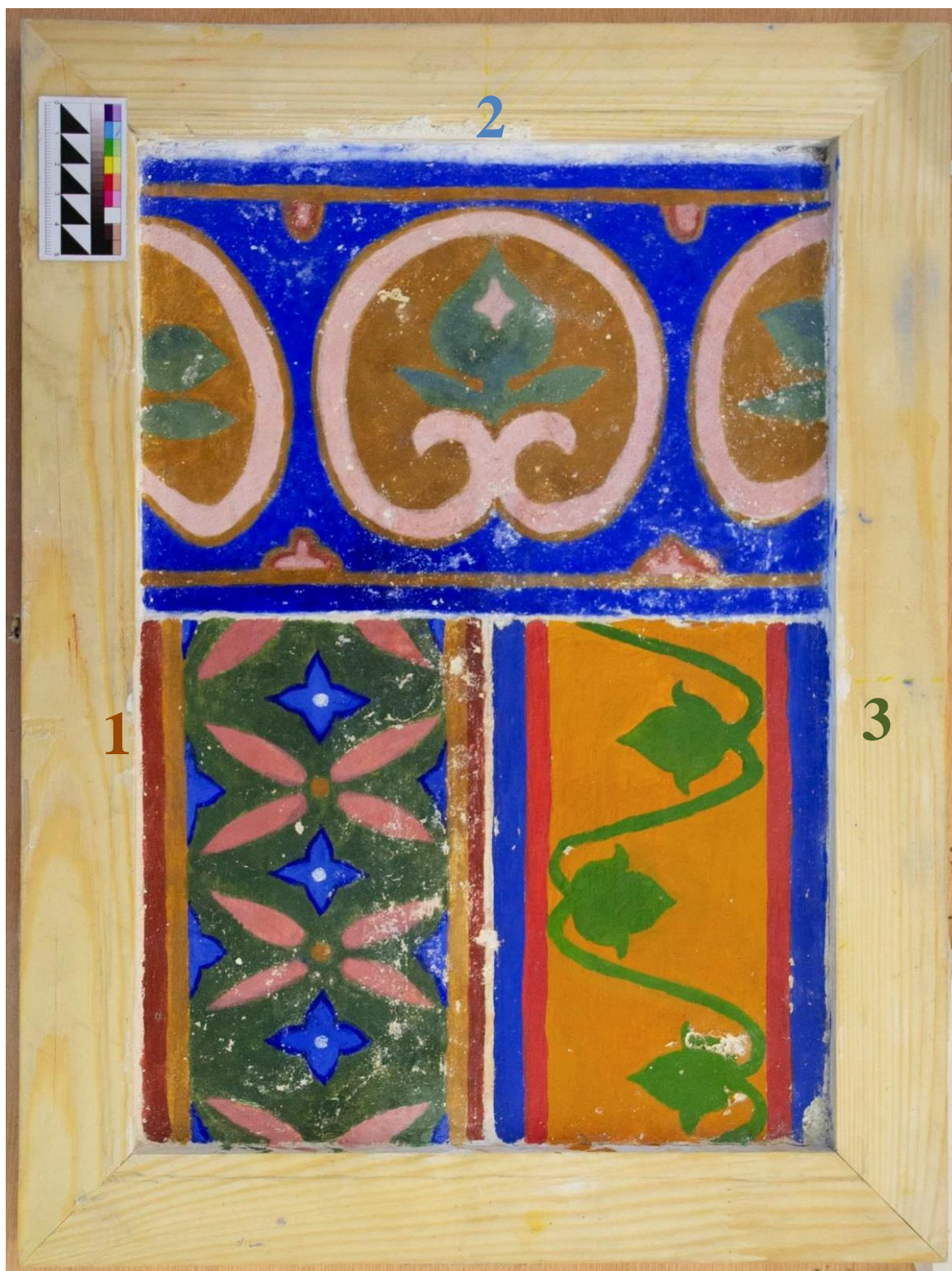
Рис. 3.2.18. После второго укрепления фрагмента один (с клеевой живописью) спиртовым раствором наноизвести Nanorestore Plus® Ethanol 5. Прямое освещение.
