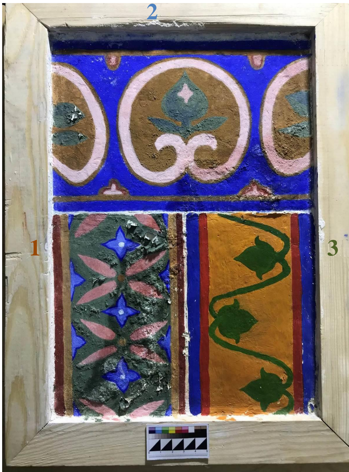
Рис. 3.2.9. В процессе разрушения. После второго цикла увлажнения водой. На фрагментах один и два (клеевая живопись и фреска) деструкция структуры живописи с выходом солей на поверхность (отставания, вздутия и деструкция красочного слоя). По краям фрагмента три отставания красочного слоя с приподнятыми краями, в правом нижнем углу. Боковое освещение.
