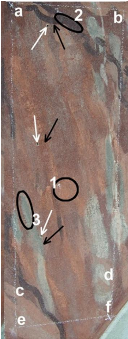
Рис.2.3.30. Фрагмент укрепления. Отображены места отбора проб и измерений: спектрофотометрия и твердость поверхности (обозначены цифрами: 1: светло-красный, 2: темно-красный и 3: серый); скорость ультразвука (обозначены буквами: a-b, c-d, e-f и b-f).
