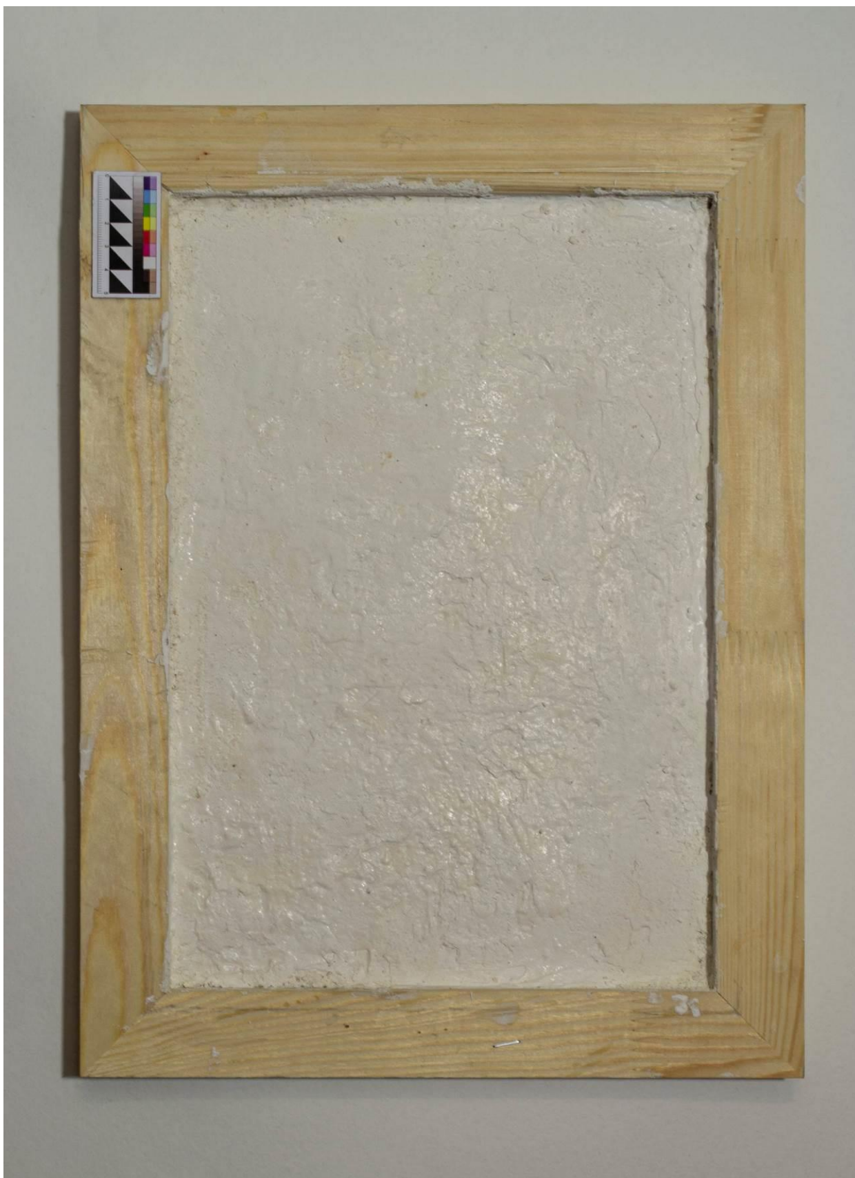
Рис. 3.2.4. Нанесен второй (основной) слой штукатурки с добавлением NaCl. Прямое освещение.
