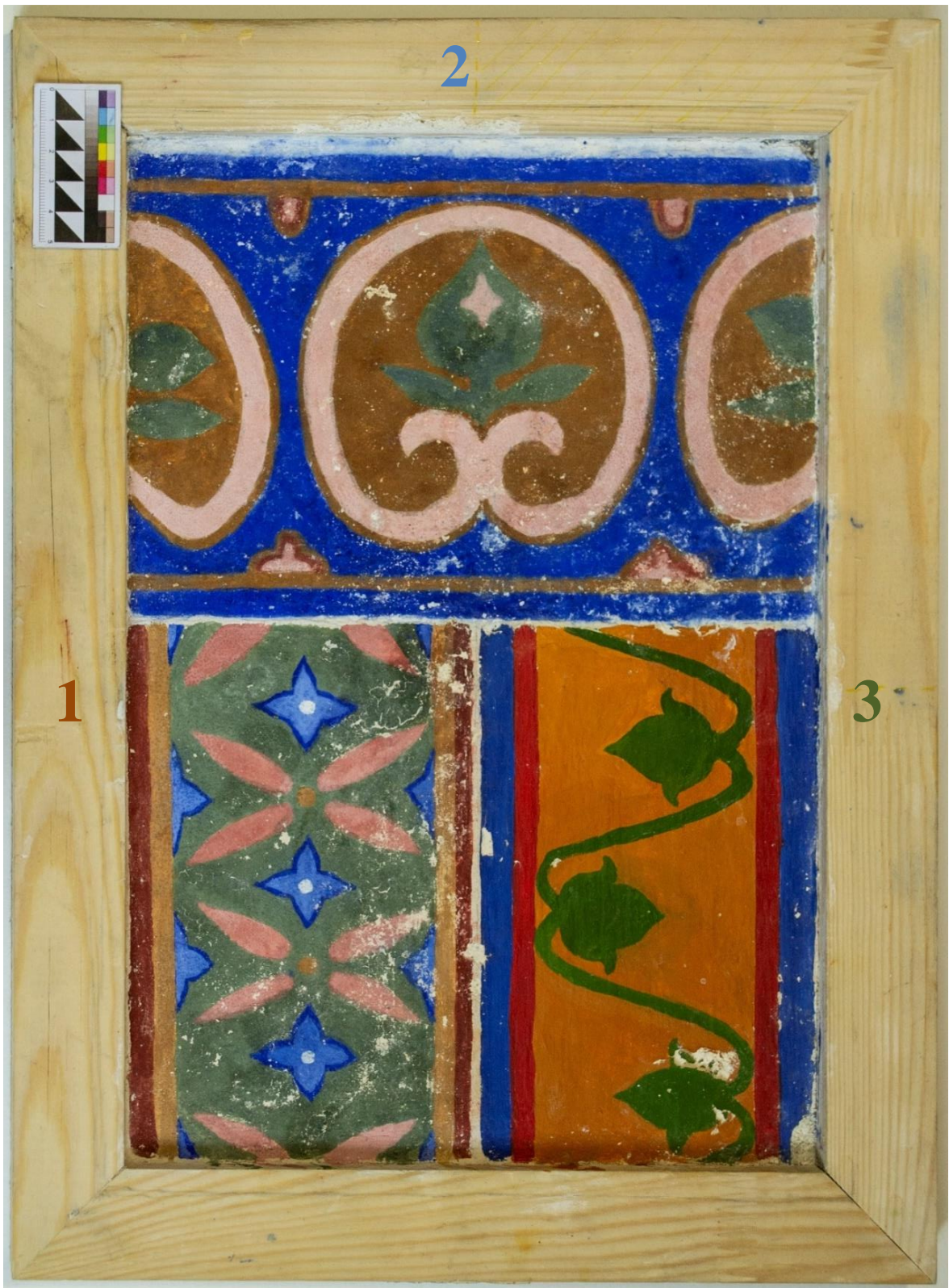
Рис. 3.2.19. После полного высыхания, после проведения процессов обессоливания и укрепления структуры живописи спиртовым раствором наноизвести Nanorestore Plus® Ethanol 5. Прямое освещение.
