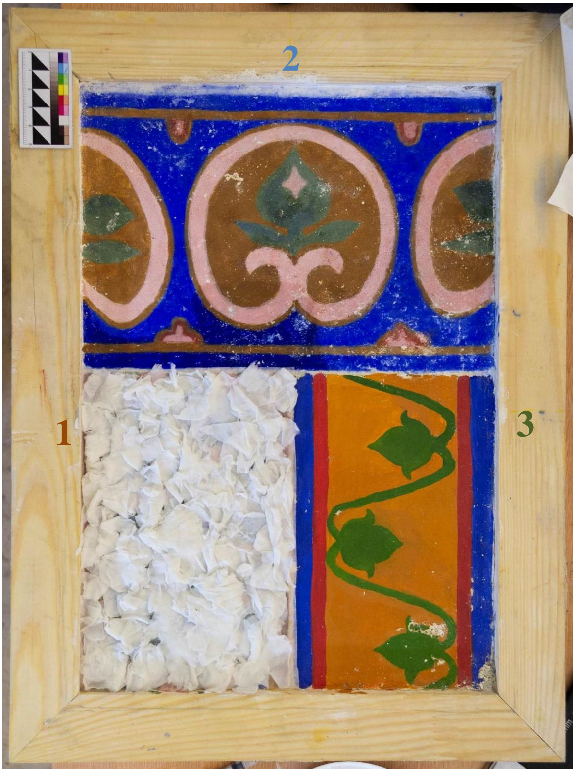
Рис. 3.2.17. В процессе второго укрепления фрагмента один (с клеевой живописью) спиртовым раствором наноизвести Nanorestore Plus® Ethanol 5. Прямое освещение.
