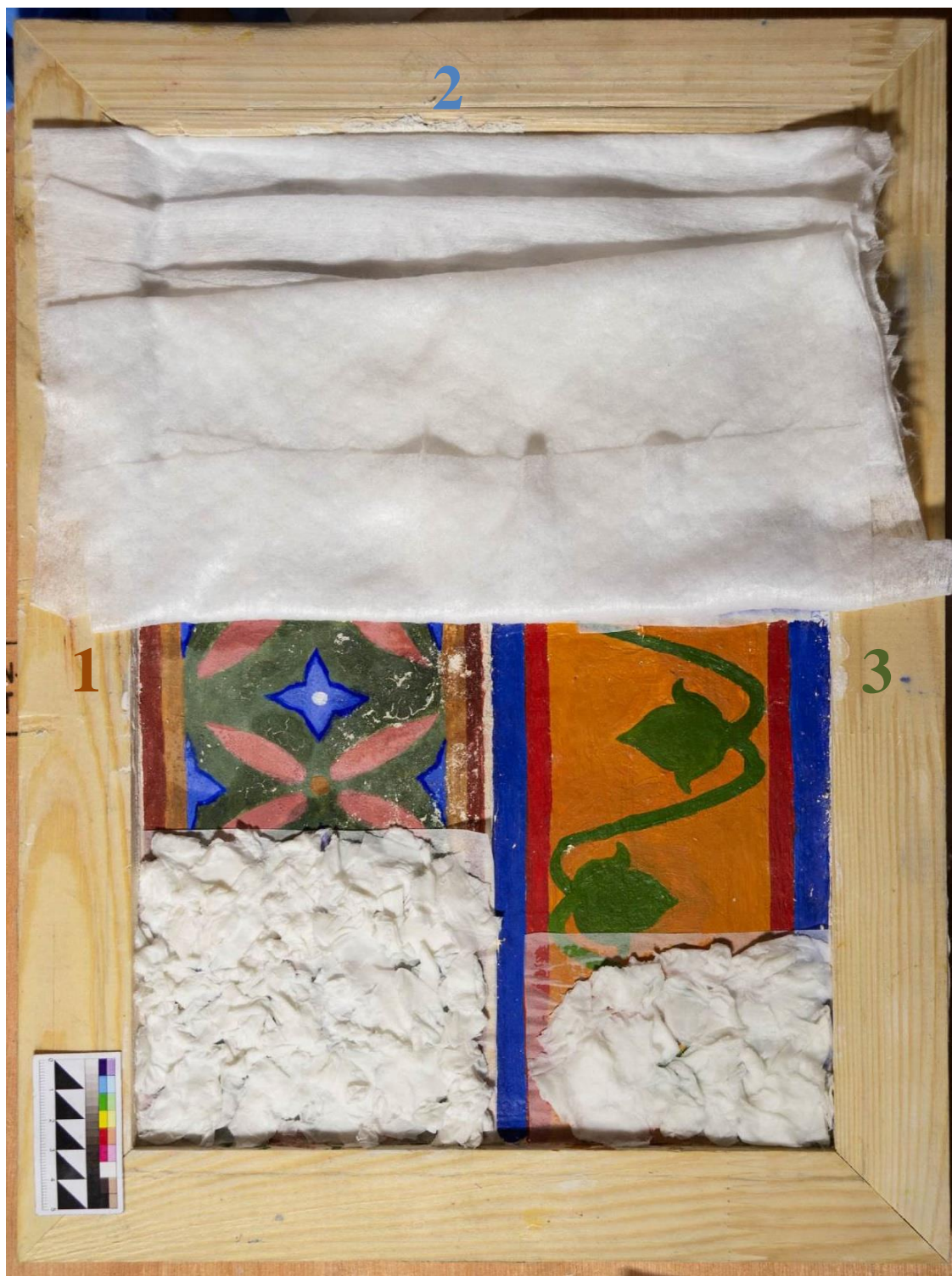
Рис. 3.2.15. На фрагменте два, после удаления солей из структуры живописи, установлен обессоливающий компресс. На фрагментах один и три (с клеевой и масляной живописью) проведено первое укрепление спиртовым раствором наноизвести Nanorestore Plus® Ethanol 5. Прямое освещение.
