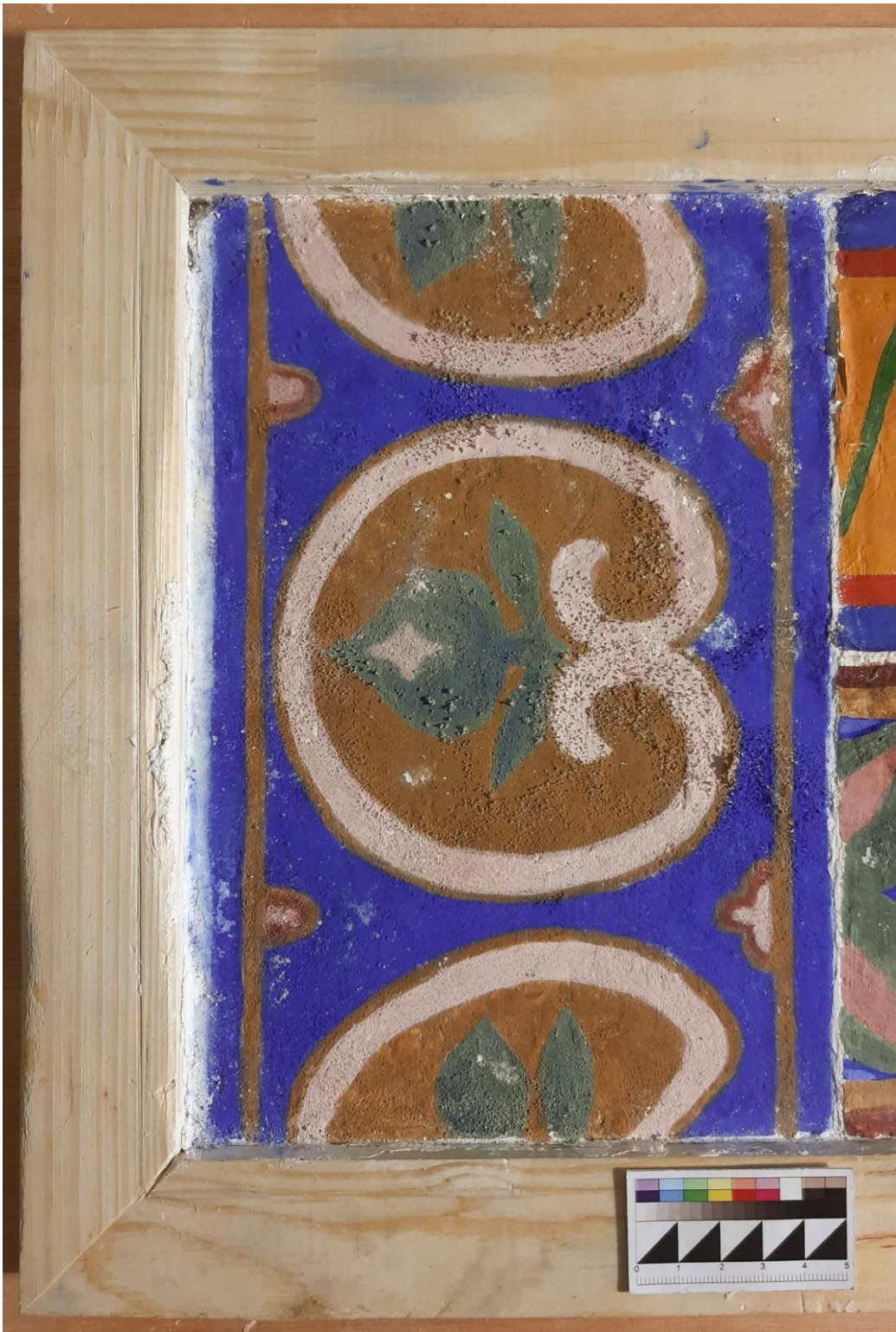
Рис. 3.2.31. После первого укрепления 3% - ым раствором осетрового клея*. Видны: солевые образования на поверхности красочного слоя, деструкция верхнего слоя штукатурки вместе с красочным слоем. Боковое освещение.
