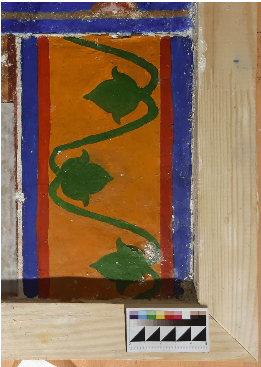
Рис. 3.2.37. После проведения двух циклов увлажнения водой. Отставания красочного слоя по краям фрагмента, в нижнем правом углу утрата красочного слоя и деструкция основы. Боковое освещение.
