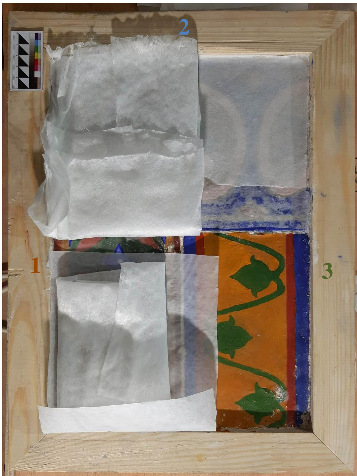
Рис. 3.2.13. На фрагменте один - установлен обессоливающий компресс**, на фрагменте два - слева установлен обессоливающий компресс, а справа - удаление солей из структуры живописи с помощью увлажненного водой компресса из японской и фильтровальной бумаги. На фрагменте три - проведено укрепление 3% раствором осетрового клея* красочного слоя по краям. Боковое освещение.
