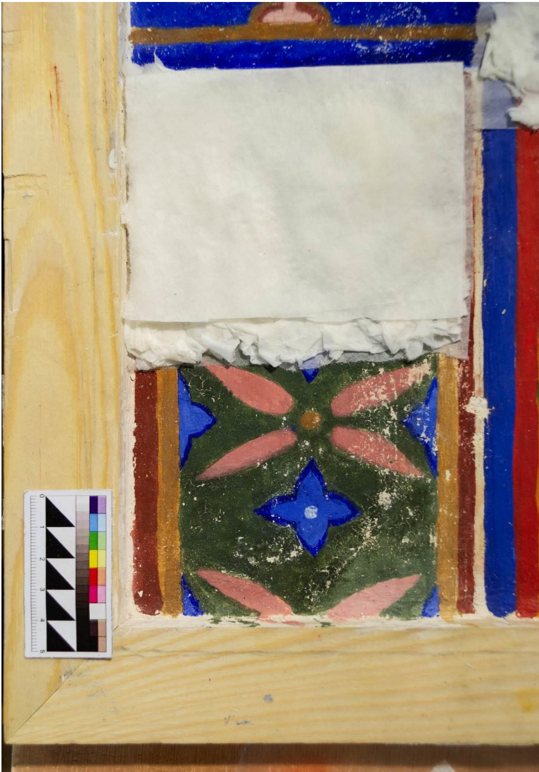
Рис. 3.2.25. В процессе первого укрепления спиртовым раствором наноизвести Nanorestore Plus® Ethanol 5. Прямое освещение.
