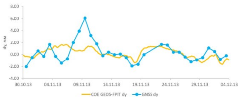
Рис. 4. Сопоставление рядов восточной компоненты, полученных из модельных данных (GEOS-FPIT) и измеренных на станциях с помощью ГНСС (Калинников и др., 2020)
