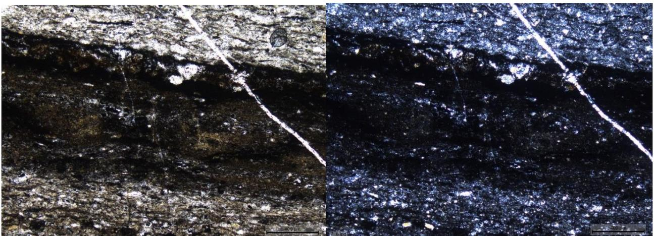
Рис. 26. 3 тип. Углисто-кремнистый сланец. Шлиф 6 (слева в параллельных николях и справа в скрещенных николях).
