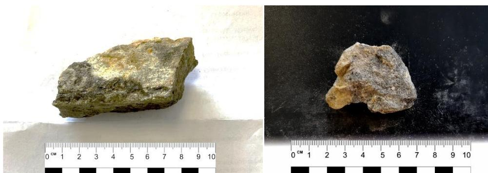
Рис. 7. Песчаник с углистым веществом (слева образец 4, справа образец 5).
