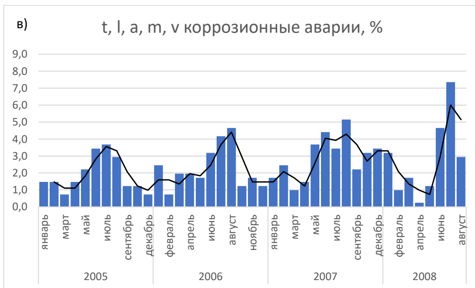
Рисунок 33. Временное распределение коррозионных аварий: а) – в b отложениях; б) – в lg отложениях; в) – в t, l, a, m, v отложениях
