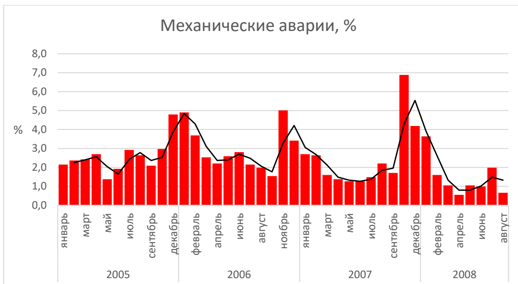
Рисунок 15. Временное распределение механических аварий сетей водоснабжения и водоотведения Санкт-Петербурга
