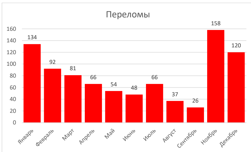
Рисунок 20. Временное распределение аварийности сетей водоснабжения по причине переломов
