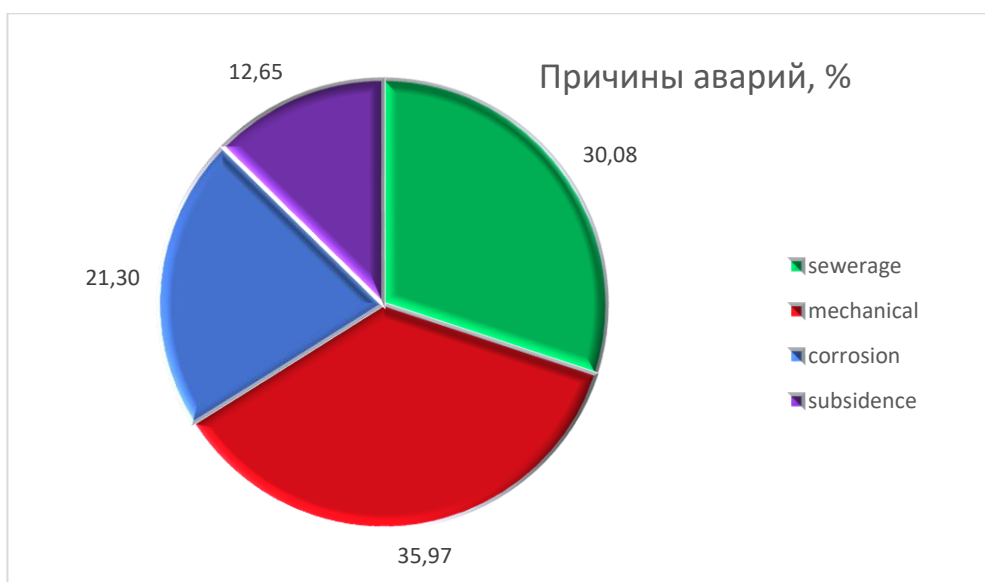
Рисунок 9. Распределение аварий Санкт-Петербурга по причинам: mechanical – механические аварии водопроводов; corrosion – коррозионные аварии водопроводов; sewerage – механические аварии канализационных сетей; subsidence – аварии дорожного покрытия
