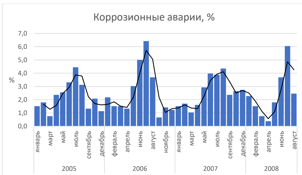
Рисунок 14. Временное распределение коррозионных аварий сетей водоснабжения и водоотведения Санкт-Петербурга
