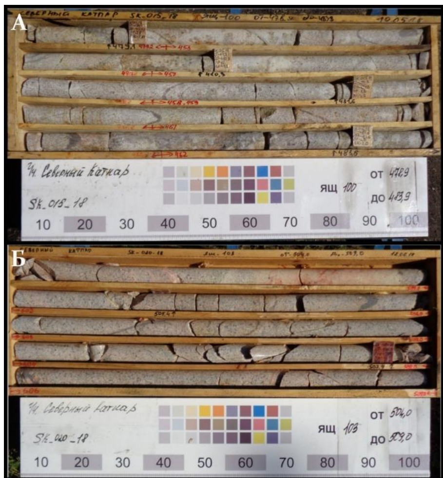
Рис. 16. Лейкократовые граниты с серией кварцевых и кварц-полевошпатовых прожилков: А – 15 скважина, Б – 20 скважина.
