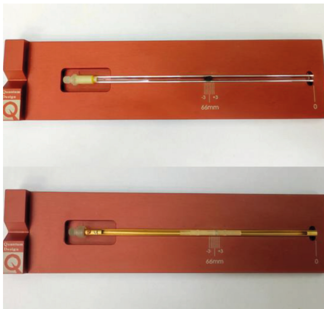
Рис. 7. Смонтированные образцы на кварцевом (сверху) и латунном (снизу) держателе
