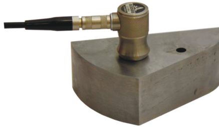
Рис. 9. Калибровка прямого совмещенного ПЭП S3567 на КО V2/25
