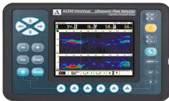
Рис. 4. Внешний вид электронного блока ультразвукового дефектоскопа «A1550 IntroVisor» с графическим индикатором и клавиатурой
