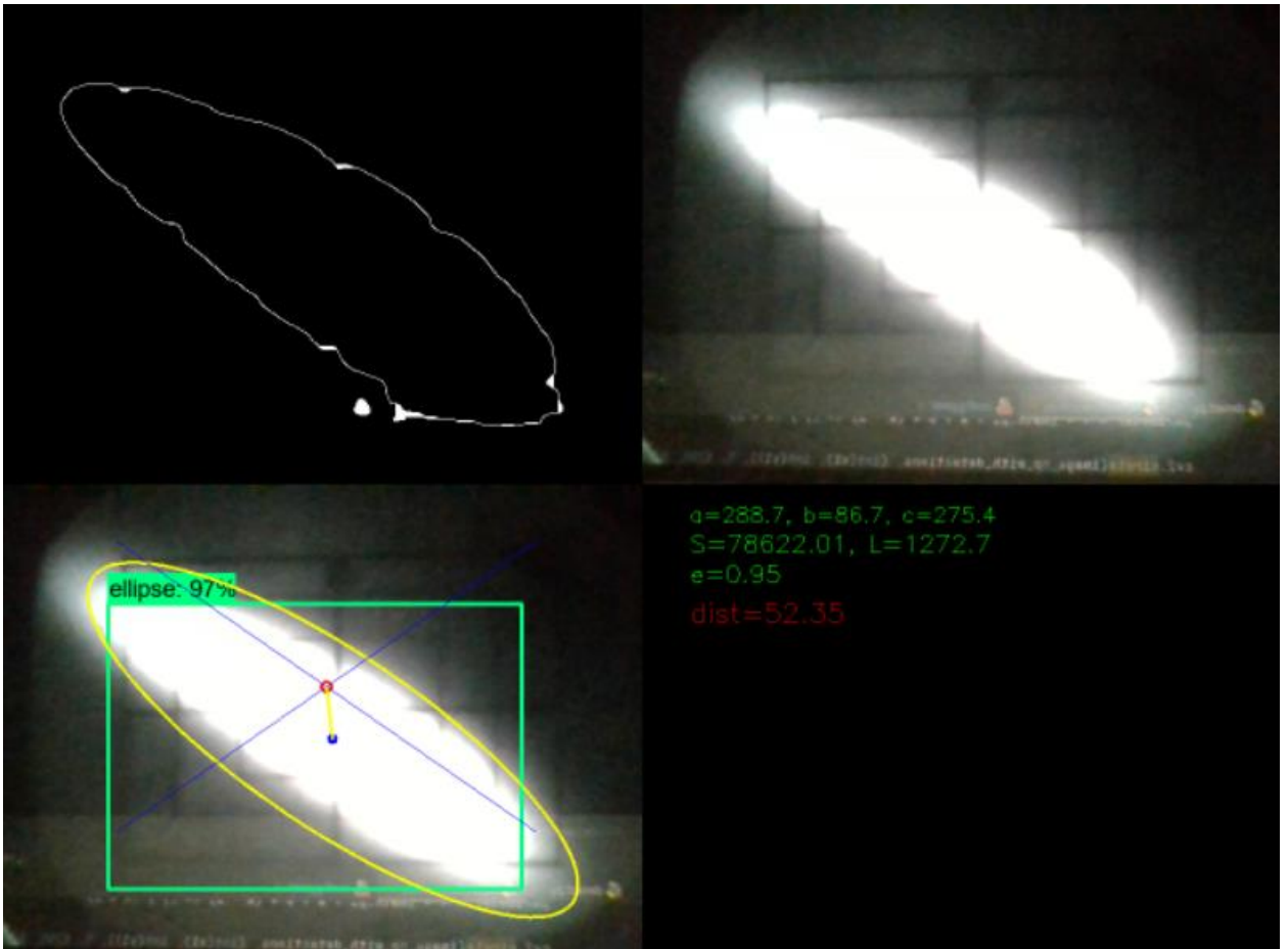
Рис. 16. Пример обработки изображения для вычисления параметров формы пучка и детектирование с помощью модели глубокого обучения
