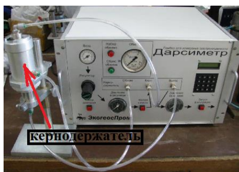
Рис. 28 Прибор для измерения газопроницаемости «Дарсиметр»
