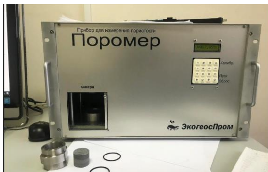
Рис. 27. Прибор для измерения пористости Поромер.
