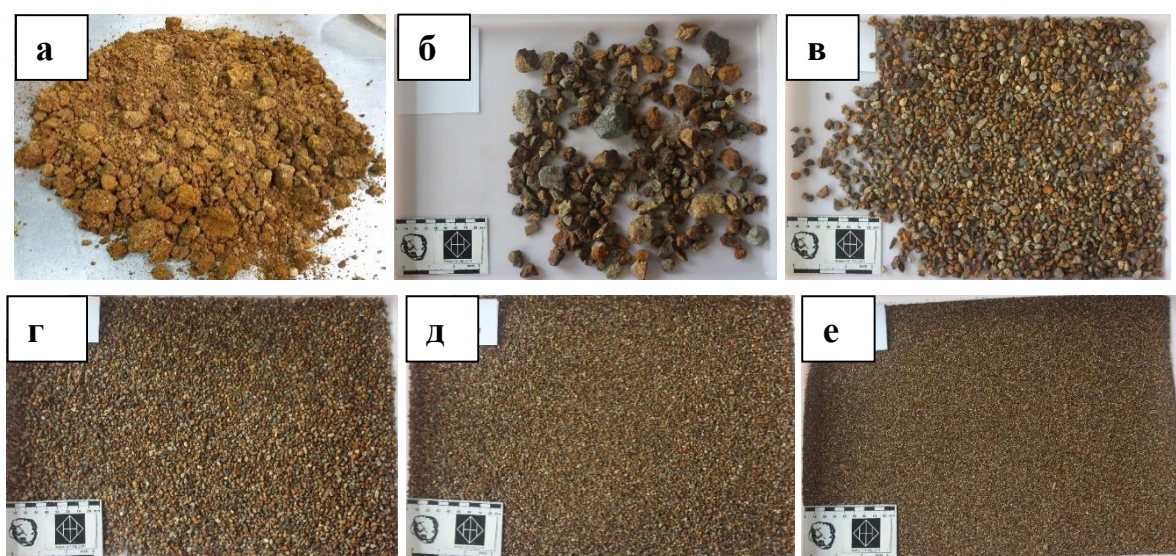
Рис. 38. Исходная проба и продукты мокрого отсева (окисленная руда). а – исходная проба, классы крупности, мм: б - +10; в - -10+5; г - -5+2.5; д - -2.5+1; е - -1+0.5.
