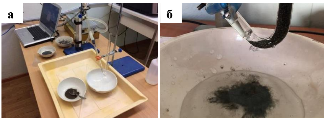
Рис. 9. Фото процесса гидросепарации. Общий вид установки HS-11 (а) и процесс разделения материала (б).
