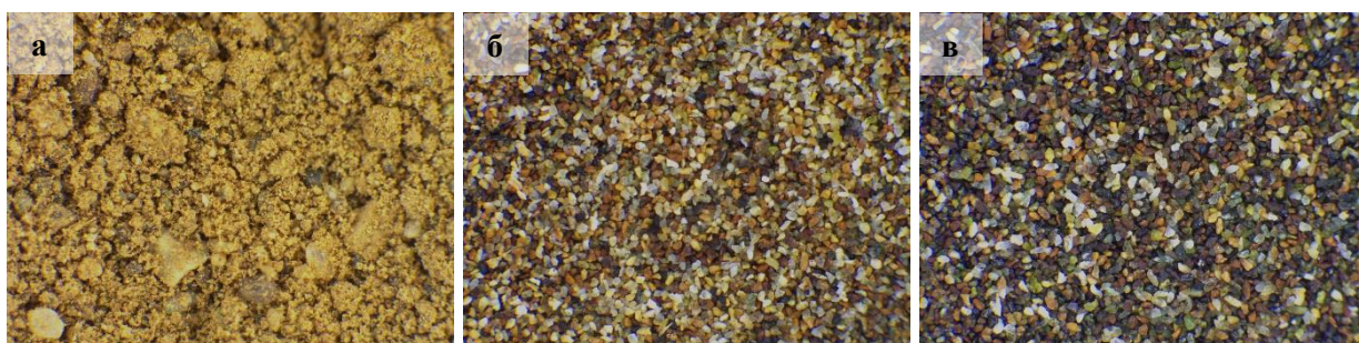
Рис. 42. Хвосты флотационного обогащения окисленных руд Кауштауской рудоносной площади. А – исходная проба хвостов флотации окисленной руды. Б – «легкая» фракция гидросепарации (HS) «хвостов» флотации окисленной руды, фр. -0.125+0.071 мм. B – «тяжелая фракция» HS хвостов флотации окисленной руды, фр. -0.125+0.071 мм.
