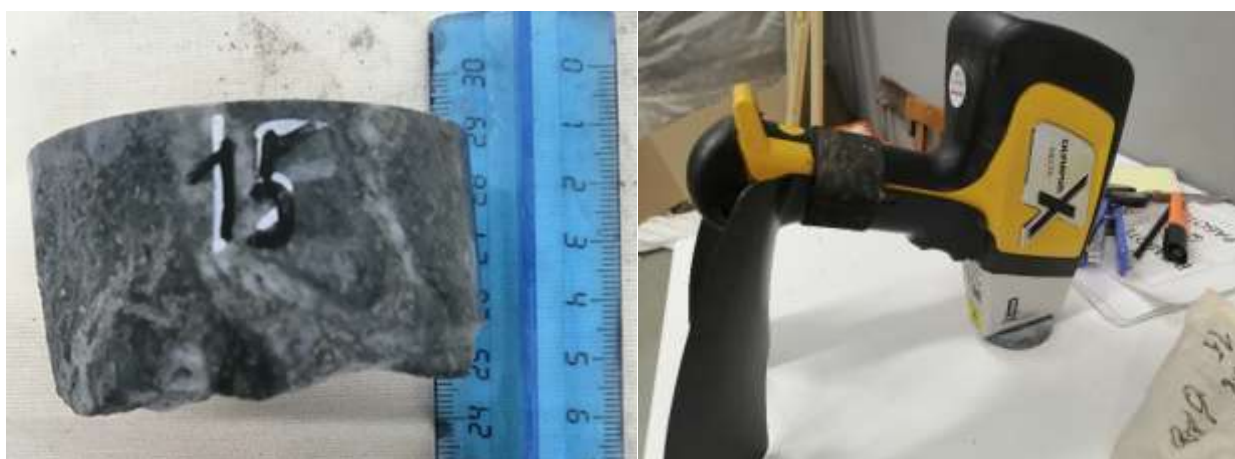
Рисунок 1. Слева – «шайба», отрезанная от образца керна. Справа – процесс измерения химического состава на образце
