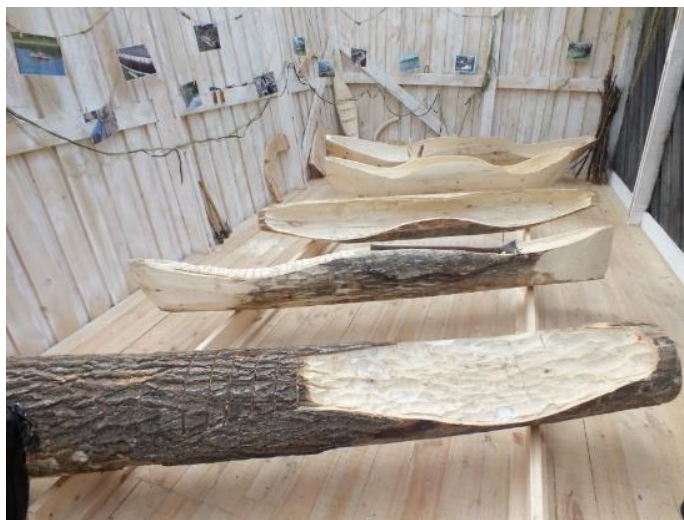
Рис. 9. Лодки-долбленки. Процесс изготовления. (Фото Г. Тюрина).
