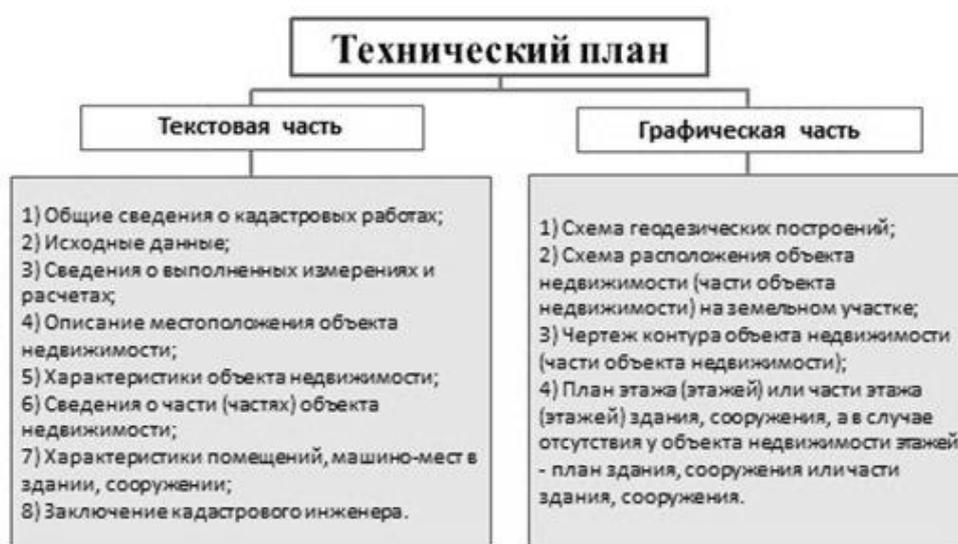
Рис. 1.6 - Части и разделы Технического плана
