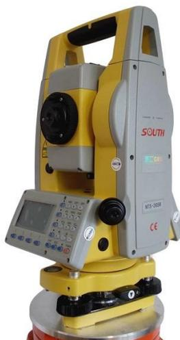
Рис. 2.1. - Тахеометр South NTS-362R6L
