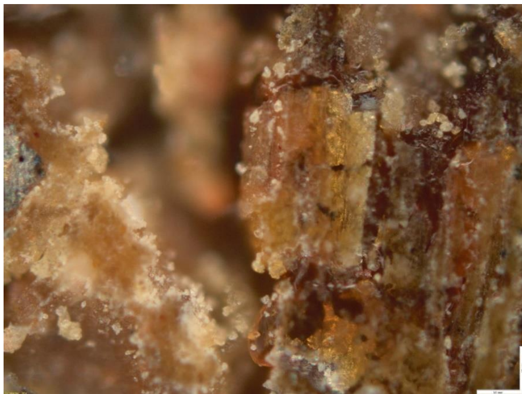
Проба 4 Рис. 19 Исследования проведены с помощью микроскопа Olympos BX 51, увеличение 10х. Вывод: под органическим слоем лака хаотично расположены металлические частички золотого цвета
