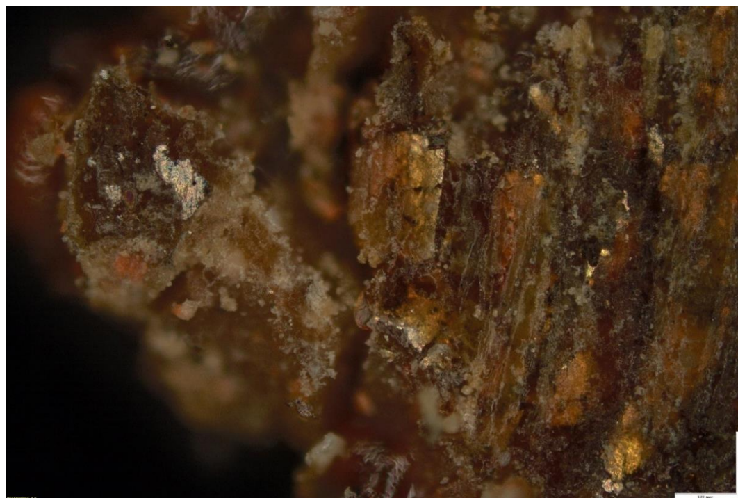
Проба 4 Рис. 20 Исследования проведены с помощью микроскопа Olympos BX 5, увеличение 20х. Вывод: размер металлических частиц золотого цвета достаточно крупный и составляют 40-100 мкм
