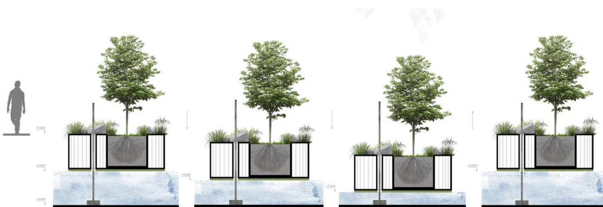
Рисунок 66. Конструктивное решение плавучих островов.
