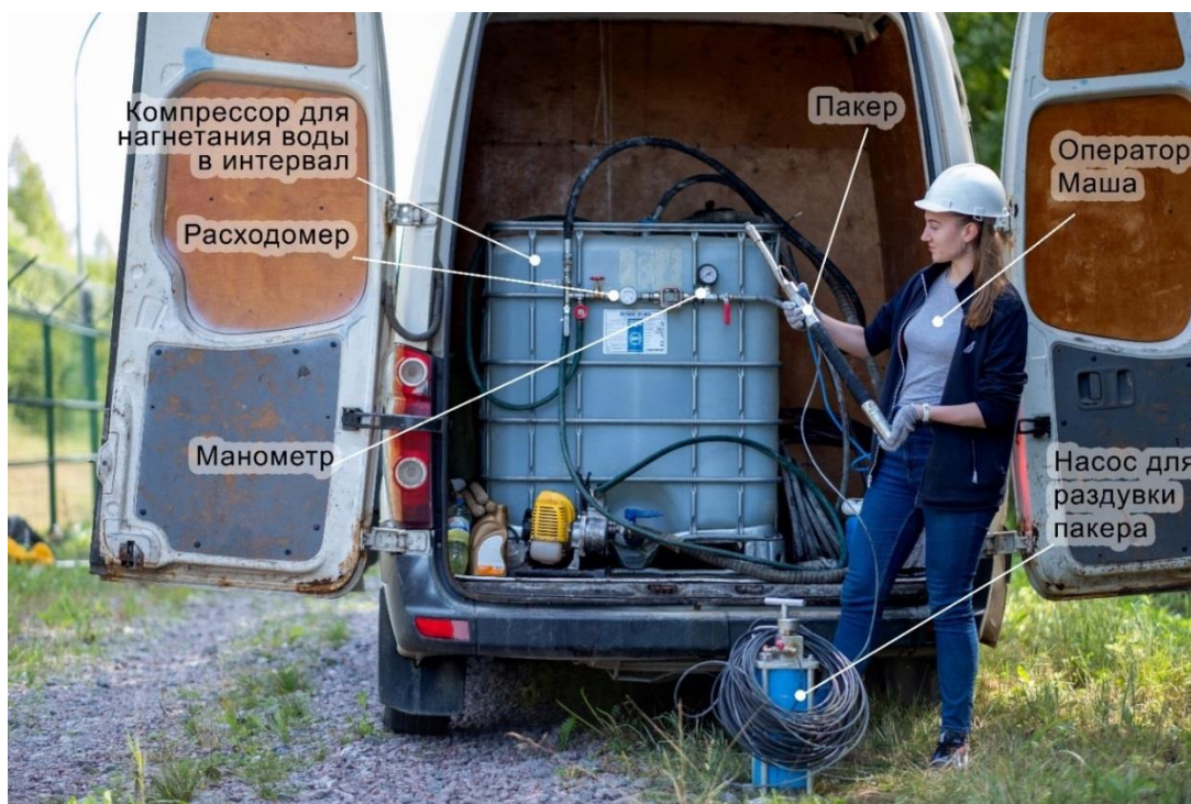
Рисунок 4.2. Состав мобильной пакерной установки
