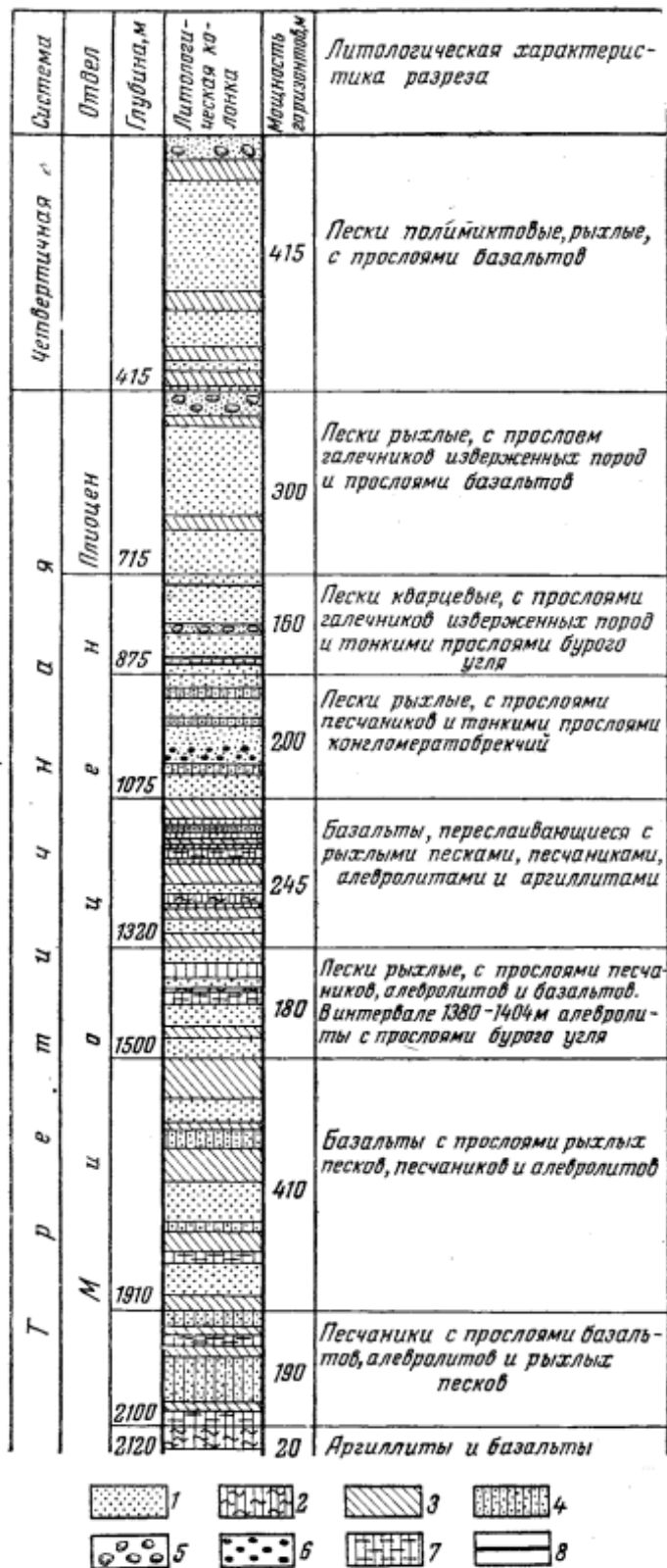
Рисунок 2 – сводный разрез опорной скв. № 2-О. Тункинская впадина (по А.Е. Повышеву)
