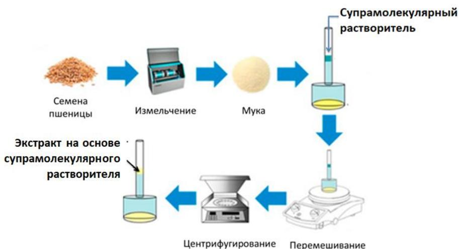
**Рисунок 6.** Схема экстракции микотоксинов из образца пшеницы [48]
