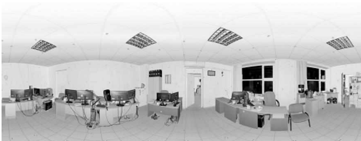
Рисунок 13. Развертка скана 360° на 180° тест-полигона с нанесёнными марками типа «песочные часы» (Войнаровский А.Е. и Тихонов С.Г., калибровка НЛС по сканам испытательного полигона, 2019).
