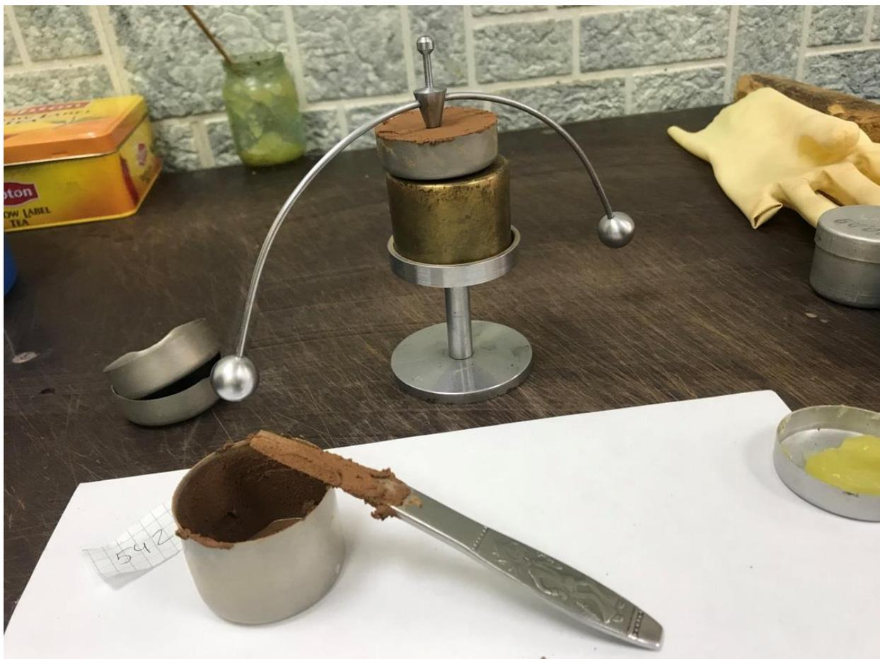
Фото 3. Выполнение опыта по определению пластичности грунта
