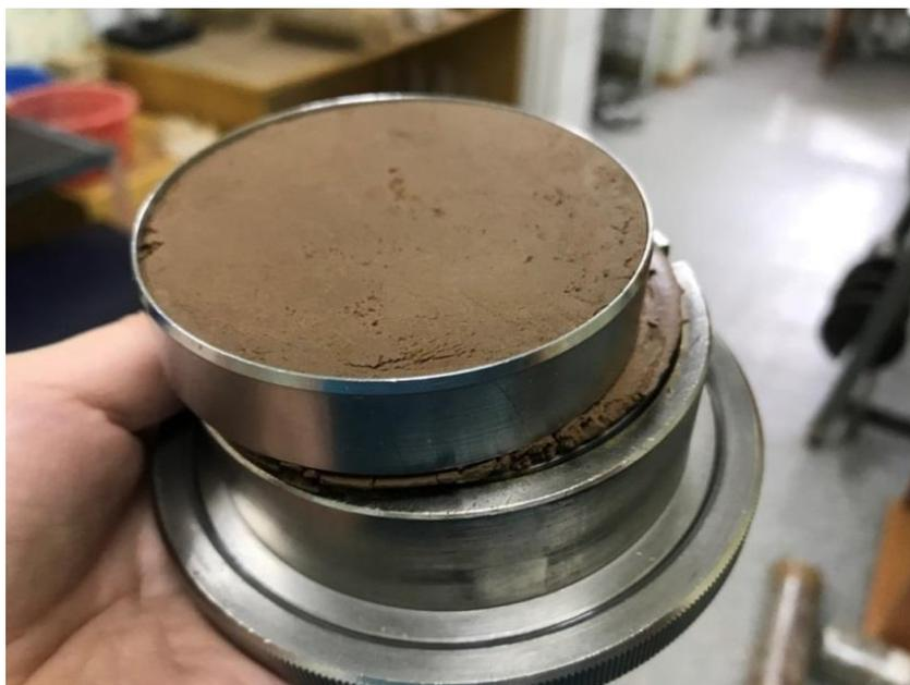
Фото 2. Выполнение опыта по определению удельного сцепления при природной влажности грунта
