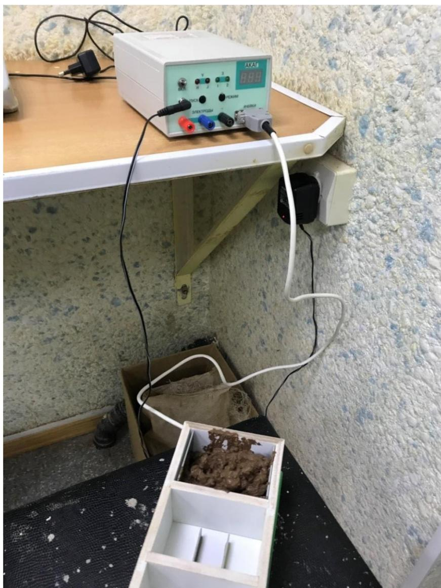
Фото. 4. Измерение коррозионной активности грунта
