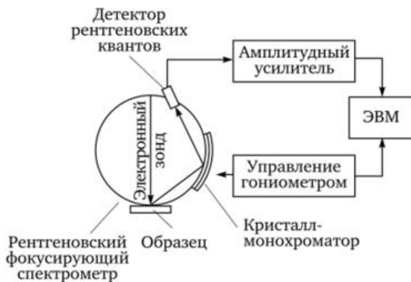
Рисунок 10. Схема эксперимента электронного микрозондового анализа (Суворов, 2018).
